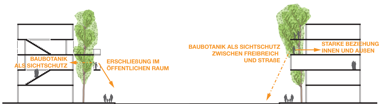
Abb. 3.2-4.: Funktion der Baubotanik beim Laubengangtypus (links) und bei den Wohnungen mit privaten Freiräumen zur Straße (rechts)
