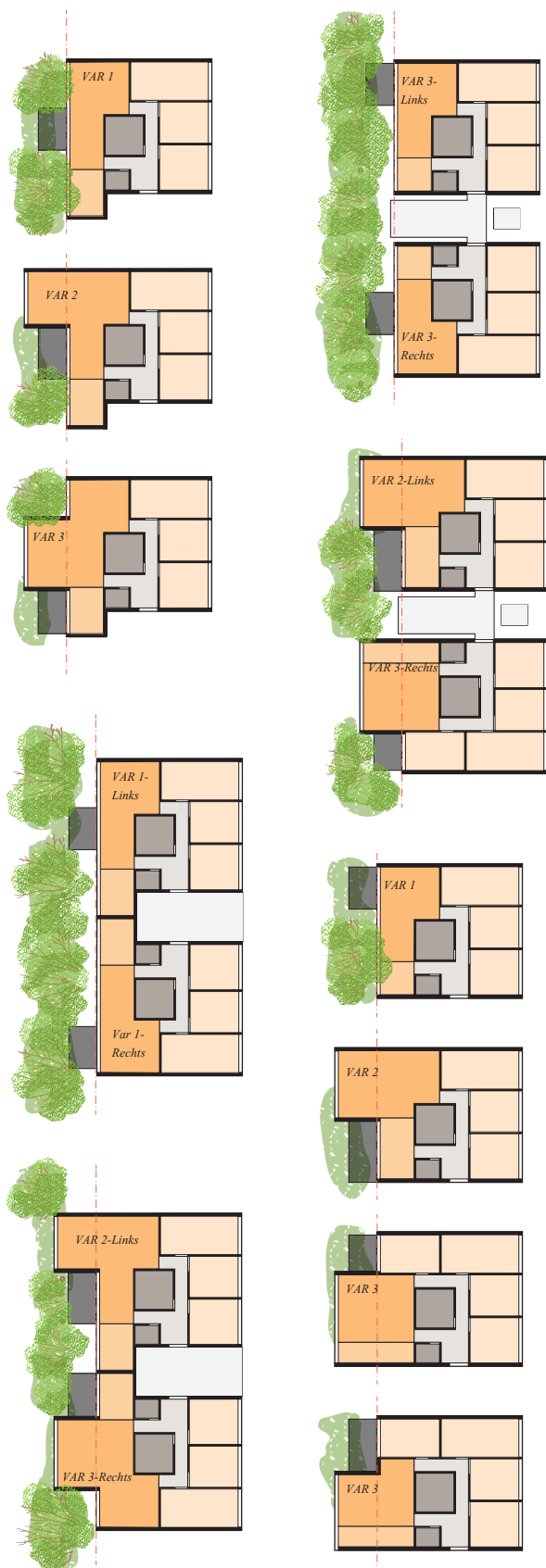
Abb. 3.2-18.: Wohnungsvarianten Baubotank an der Westfassade mit innenliegender Erschließung.
