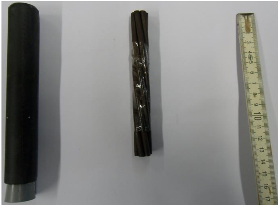
Abb. 103: Links Sondenrohr mit grauem Stöpsel am Boden; In der Mitte Spannbetonlitze \varnothing 15,6 mm.
