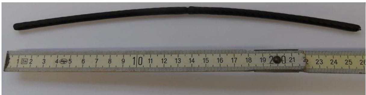
Abb. 54: Zwei \varnothing 5 mm Stahldrahtseilstücke durch einen Schrumpfschlauch \varnothing 6,4/ \varnothing 3,2 mm miteinander verbunden.
