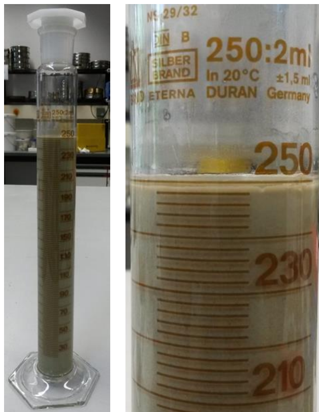
Abb. 40: Absetzmaßbestimmung in 250 ml Standzylinder für die Suspension mit 220 g/l Bentonit + 100 g/l CEM1. Rechts der Stand nach 3 h entsprechend LQS EWS (ca. 1 ml Abnahme entsprechend 0,4 Vol. %).
