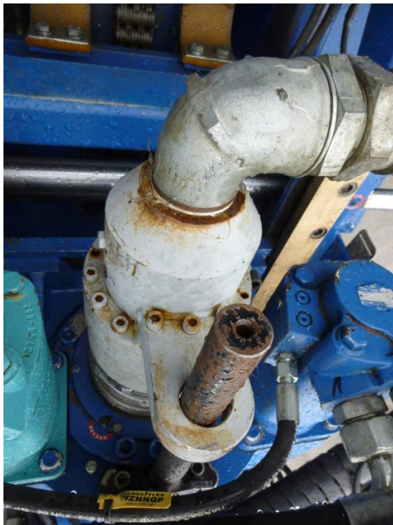
Abb. 142: Kraftdrehkopf mit Schleifring zur Übertragung der Widerstandsmesswerte.
