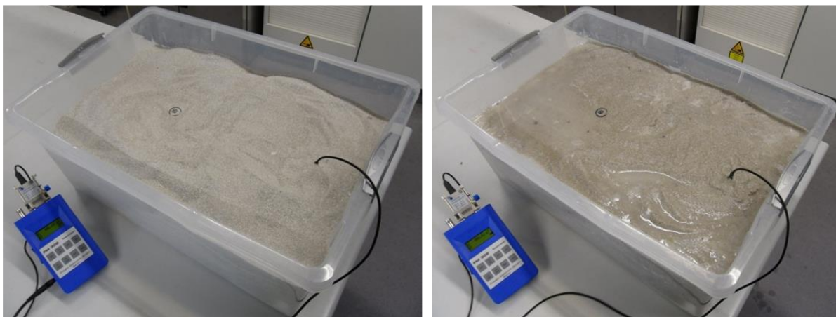
Abb. 89: Versuchsaufbau gefüllt mit trockenem Sand (links) und mit wassergesättigtem Sand (rechts).
