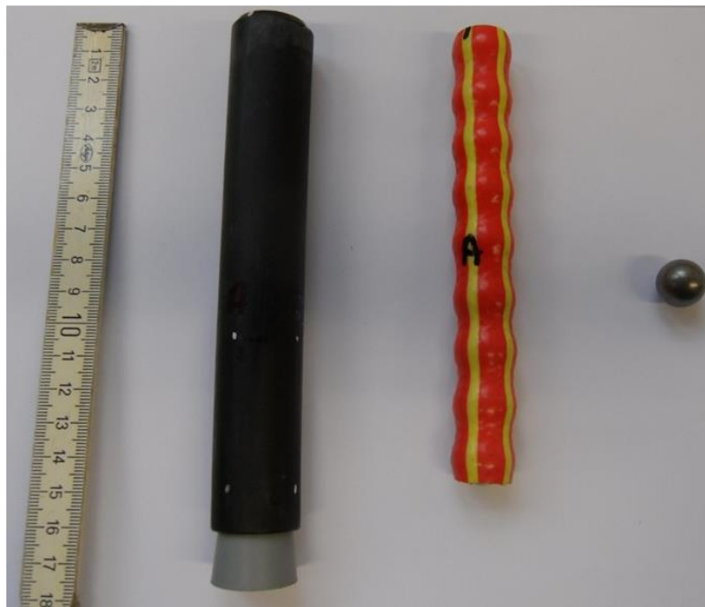
Abb. 50: Von links nach rechts : Maßstab, Sondenrohr für Magnetisierungs- und Messstand, Gardena Cord-Schlauch gefüllt mit \varnothing 15 mm Kohlenstoffstahlkugeln, Einzelne Kohlenstoffstahlkugel.
