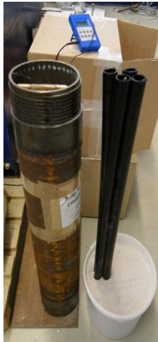
Abb. 99: Bohrrohr und nebenstehend sandgefüllter Eimer mit Koch Erdwärmerohr 32,0 x 2,9 mm.
