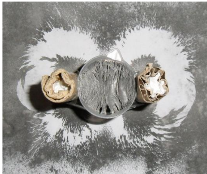
Abb. 18: Magnetfeld zweier parallel angeordneter Stabmagneten aus dem KA, Kunststoffgefäßes \varnothing 43 mm.
