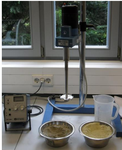
Abb. 14: Rührwerk und Utensilien für die Suspensionsherstellung.
