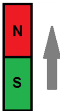
Abb. 2: Durch einen Pfeil gekennzeichnetes magnetisches Moment (erstellt nach Callister & Rethwisch 2013).
