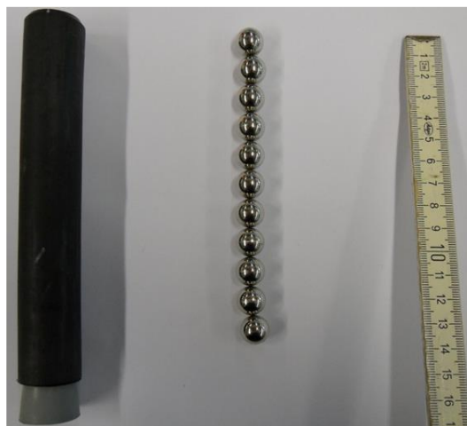
Abb. 117: Links: Sondenrohr mit grauem Stöpsel am Boden; In der Mitte: Neodym-Magnetkugelnkette bestehend aus 11 x \varnothing 12,7 mm Kugeln
