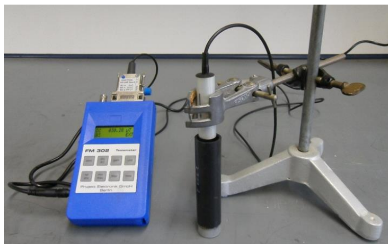
Abb. 41: Messung der Flussdichte eines jeweils mit Magnetit und Nano-Eisen Pulver gefüllten PE-Verfüllrohrs ( \varnothing 25 mm, 100 mm lang).
