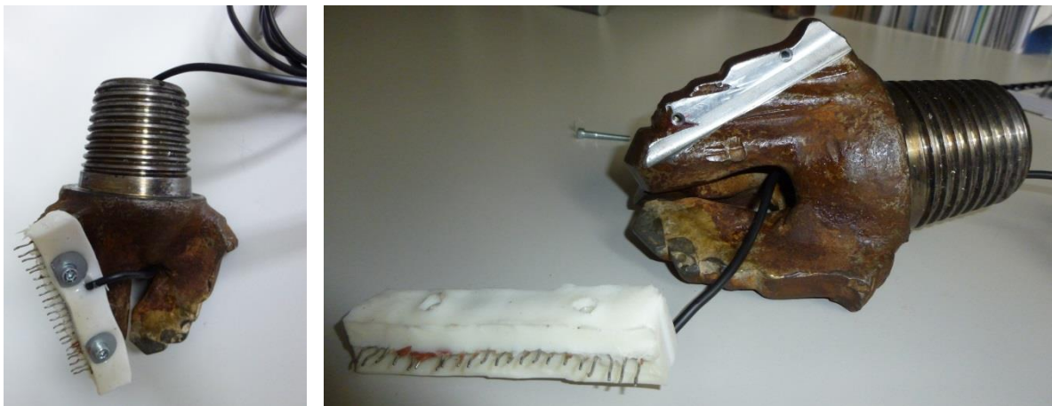
Abb. 34: Bohrkopf für Laborversuch zur elektrischen Widerstandsmessung.
