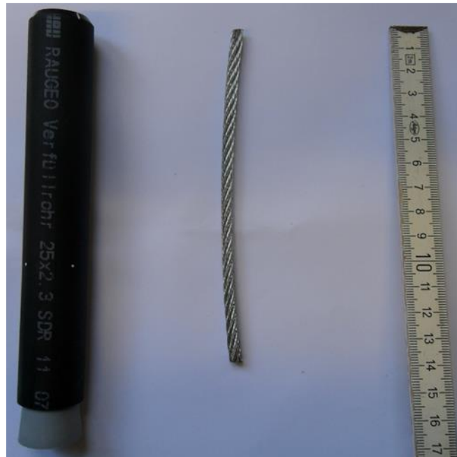
Abb. 53: Links Sondenrohr mit grauem Stöpsel am Boden; In der Mitte Stahldrahtseil \varnothing 5 mm.
