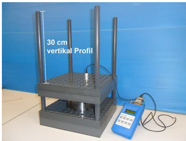
Abb. 67: 30 cm vertikal Profil zum verfahren der Kopfplatte.
