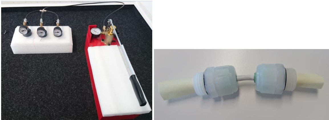
Abb. 150: Druckkammer zum Testen der Druckfestigkeit des Gehäuse und der Kabeldurchführung (rechts)
