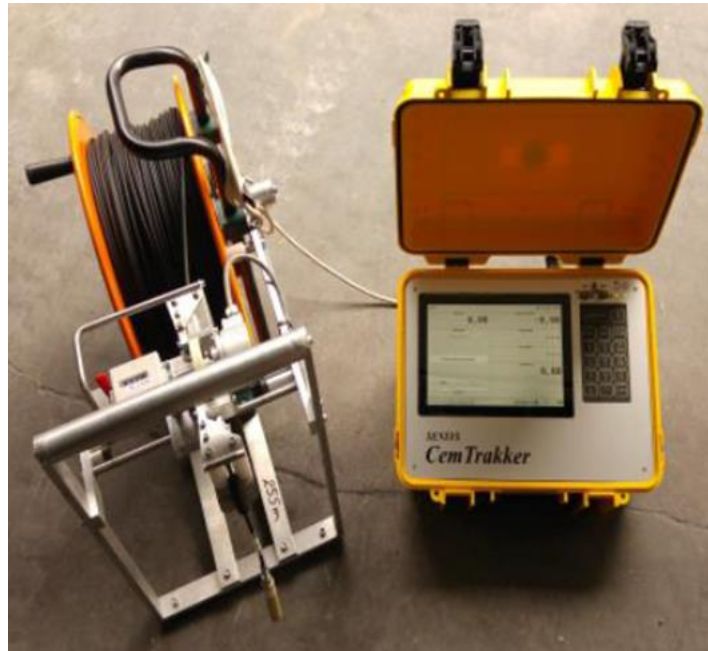
Abb. 13: Cem Trakker Messkoffer mit Display und Kabeltrommel mit Messsonde (Santherr Geothermietechnik).
