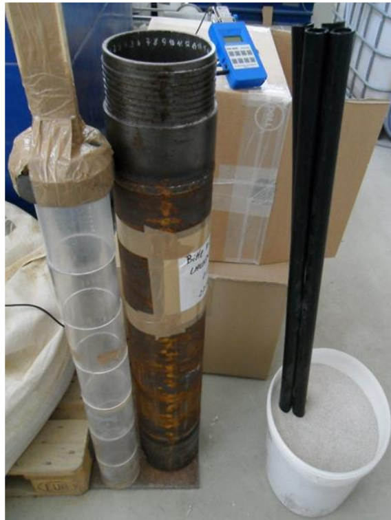
Abb. 100: Durchsichtige Kunststoffzylinder (7 Stück übereinander, je 134 mm) neben Bohrrohr und Erdwärmerohr.
