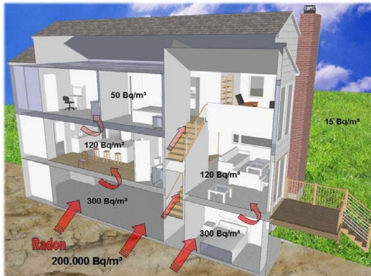
Abbildung 2: Verteilung der Radonkonzentration in einem Gebäude;
