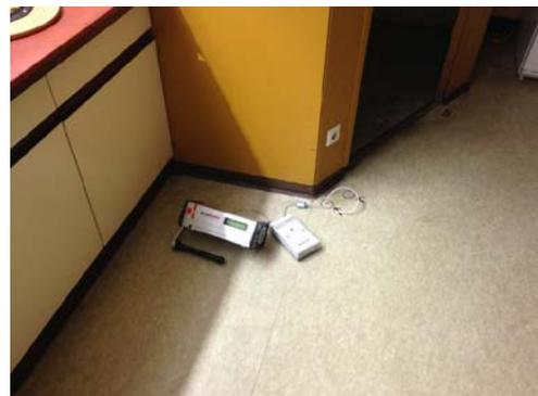
Abbildung 24: Bilddokumentation der Radon-Eindringpfadbestimmung an zwei Bohrungen in einem BioChemie-Labor
