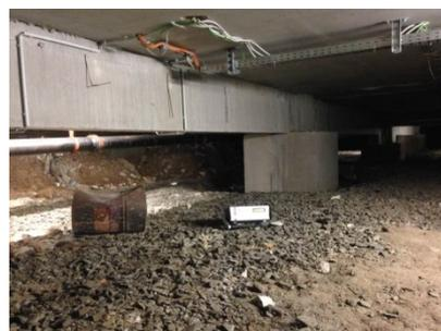
Abbildung 27: Bilddokumentation der Radonmessung in einem Kriechkeller unter dem Verwaltungsteil einer Schule
