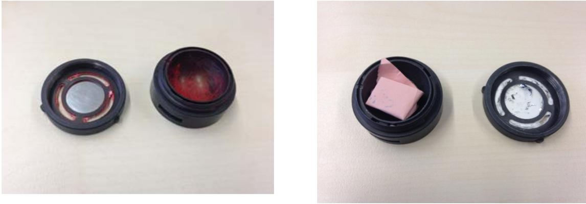
Abbildung 11: Beispielabbildung für nicht auswertbare Radondetektoren
