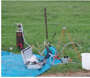
Abbildung 1.2-5: Probennahme an einer Grundwassermessstelle
