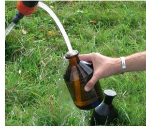
Abbildung 1.2-7: Abfüllen der Grundwasserprobe
