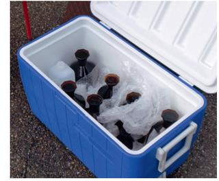
Abbildung 1.2-8: Proben transport in der Kühlbox
