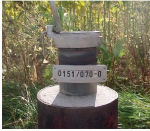
Abbildung 1.2-1: Grundwassermessstelle
