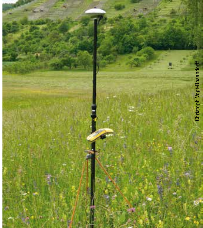
Abbildung 3: Zur satellitengestützten Ortsbestimmung wurden die Stichprobenflächen mit dem GNSS-Empfänger Trimble® GeoXH™ eingemessen.
