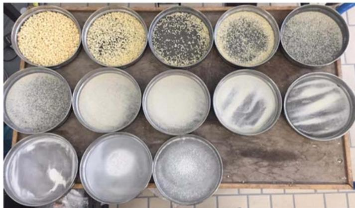
Abbildung 13: Siebanalyse mittels R20/3 Siebreihe an zerkleinerte WDVS-Modellsysteme
