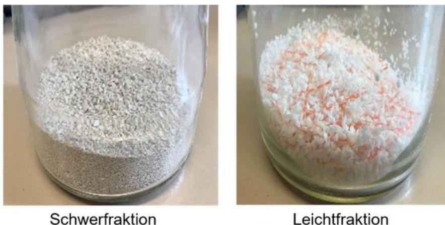
Abbildung 19: Schwer- und Leichtfraktion der Grobfraktion der EPS-Modellsysteme, nach dem ersten Sichterdurchgang mit einem Volumenstrom von  $15 \text{ Nm}^3/\text{h}$
