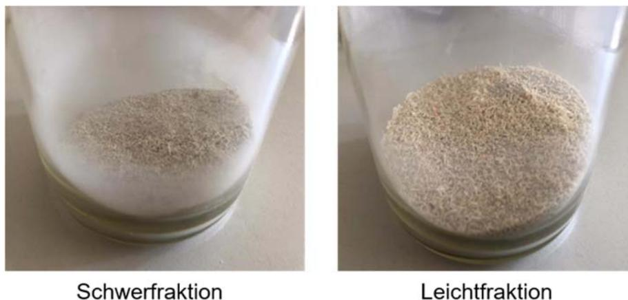
Abbildung 34: Schwer- und Leichtfraktion der Feinfraktion der XPS-Modellsysteme nach dem ersten Sichterdurchgang mit einem Volumenstrom von  $8 \text{ Nm}^3/\text{h}$
