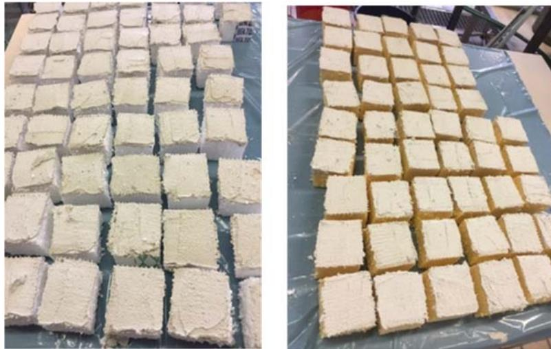
Abbildung 7: Konzipierte WDVS-Modellsysteme mit EPS (links) und XPS (rechts) als Dämmstoffmaterial
