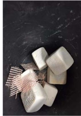
Zerkleinerungsprodukt der Kugelmühle bei Verwendung von Systemen mit XPS als Dämmstoff
