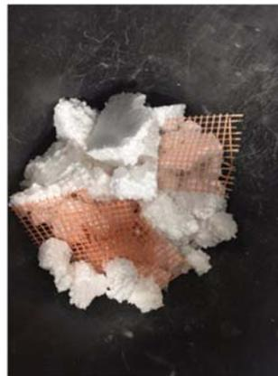
Zerkleinerungsprodukt der Hammermühle von ausgewählten Stücken der zerkleinerten Systeme
