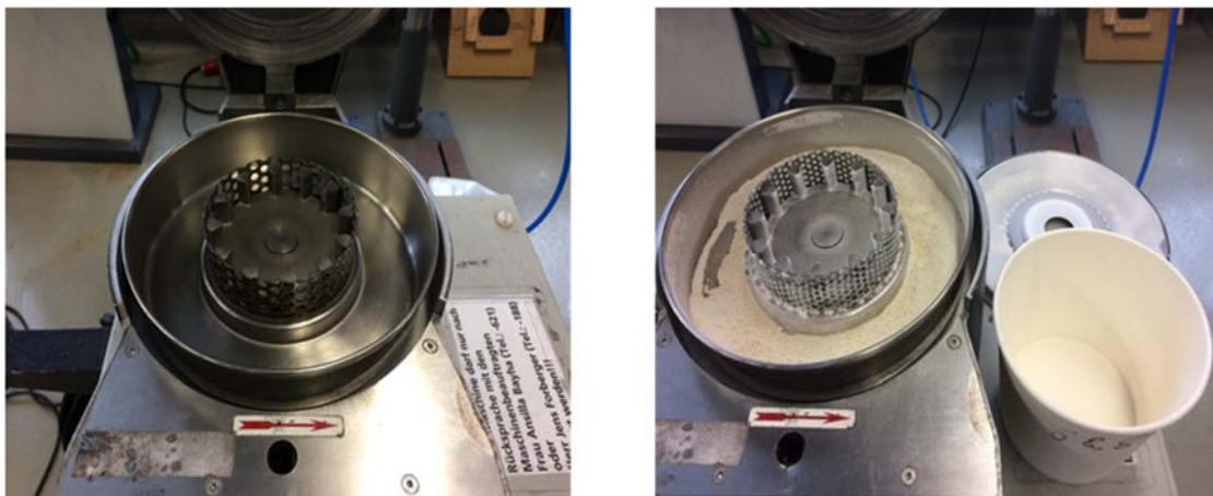
Abbildung 37: Konfiguration der ZM 100 (mit 6 mm Siebeinsatz)
