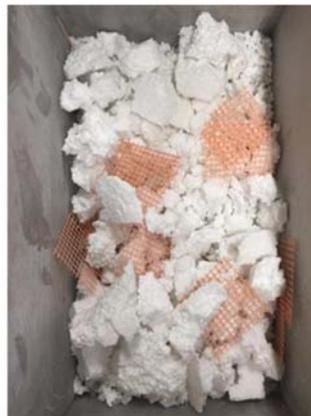
Zerkleinerungsprodukt der Hammermühle bei Verwendung von Systemen mit EPS als Dämmstoff
