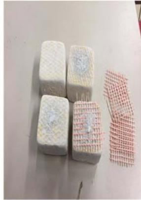
Zerkleinerungsprodukt der Kugelmühle bei Verwendung von Systemen mit EPS als Dämmstoff
