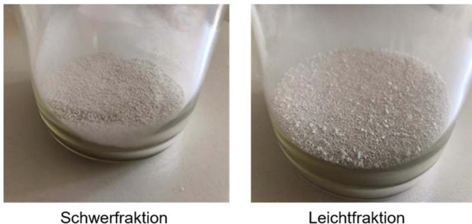
Abbildung 23: Schwer- und Leichtfraktion der Feinfraktion der EPS-Modellsysteme nach dem ersten Sichterdurchgang mit einem Volumenstrom von  $8 \text{ Nm}^3/\text{h}$
