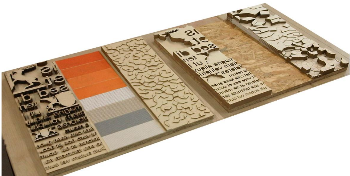
Abb. 13 Tiefzieh-Werkzeugplatten für Versuche zur Herstellung von Strukturen oder Verformungen innerhalb einer ebenen Platte ©ITKE
