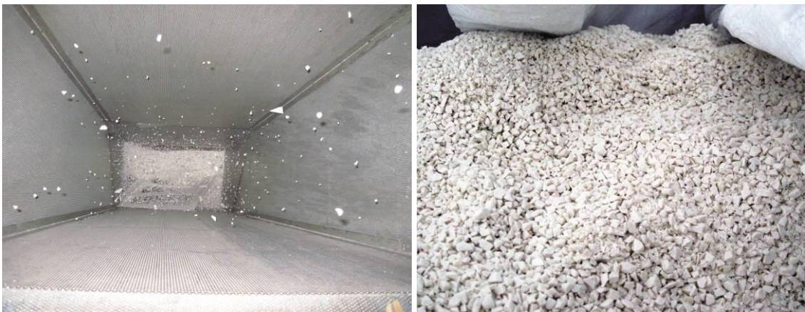
Abb. 47 Shreddern der Plattenabfälle Abb. 48 Regranulierung ©BAUER THERMOFORMING
