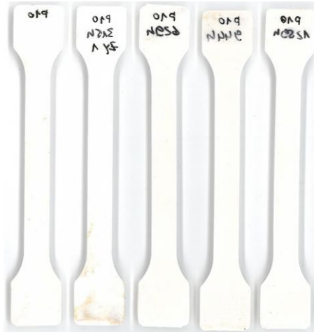
Abb. 5 Prüfstab der finalen Rezeptur und Stäbe nach 315h, 629h, 944h und 1259h Bestrahlung
