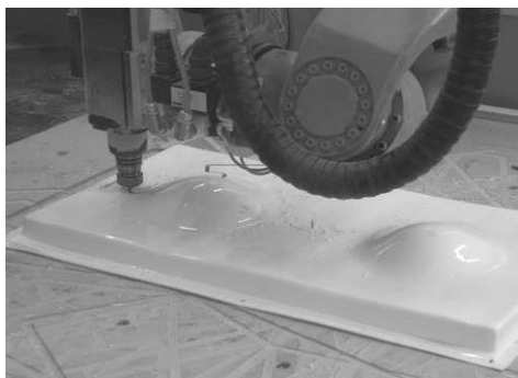
Abb. 26 und Abb. 27 CNC-Konturfräsen @ITKE
