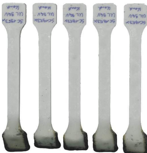
Abb. 3 Brandversuche auf Materialebene nach UL94-V
