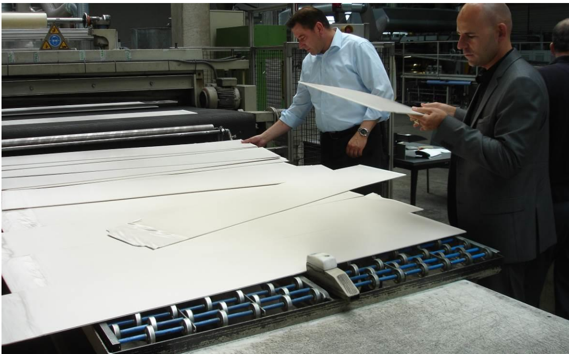
Abb. 10 Begutachtung der extrudierten Platten hinsichtlich Oberflächenqualität ©spek DESIGN
