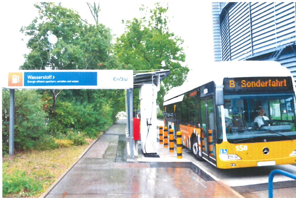
Abbildung 9: Betankung des Busses
