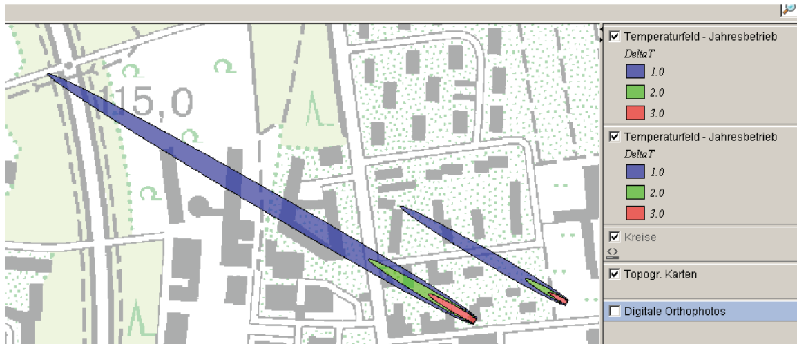
Abbildung 2: Mit der Fachanwendung Grundwasser berechnete Temperaturfelder
