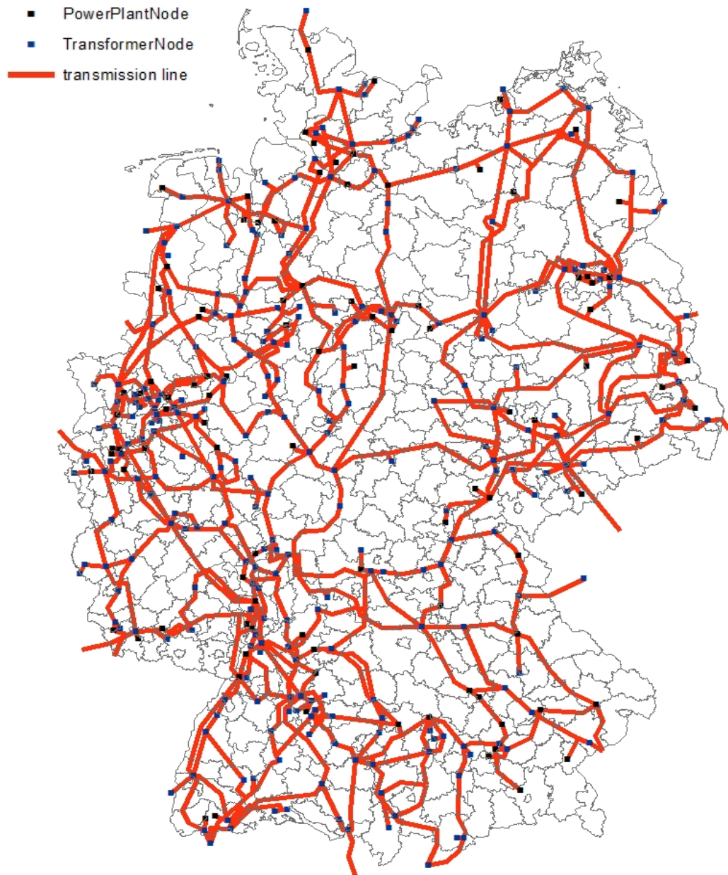
Abb. 4-5: Modellierung des Übertragungsnetzes (380 kV und 220 kV) in PERSEUS-NET [84]
