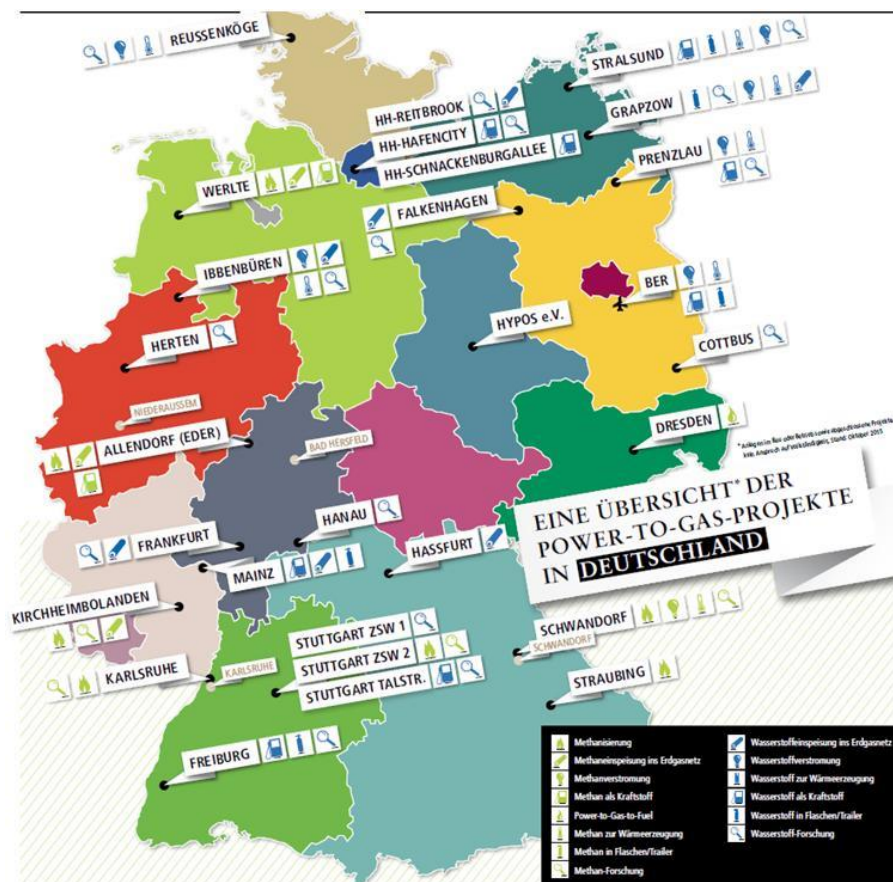
Abb. 7-2: Übersicht zu PtG-Demo- und Forschungsanlagen im Bundesgebiet ( http://www.dvgw-innovation.de/presse/power-to-gas-landkarte/ )
