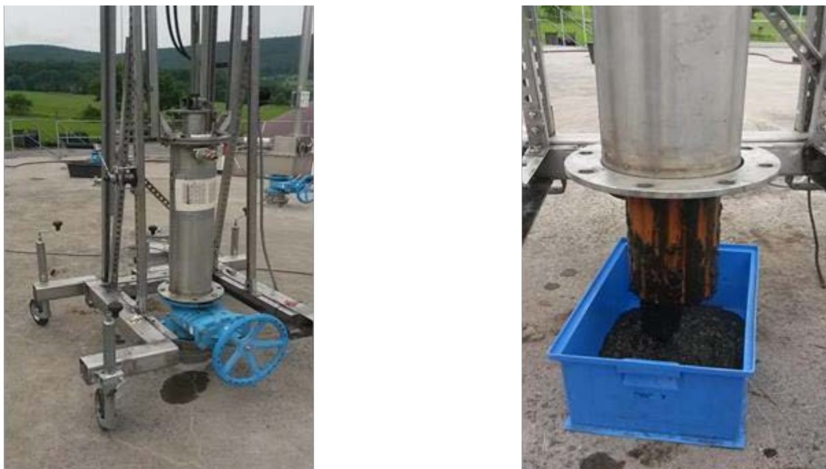
Abbildung 15: links: Probennehmer auf Schleuse; rechts: entleeren der Substratprobe aus innerem Kunststoffrohr (Ruile, 2015)
