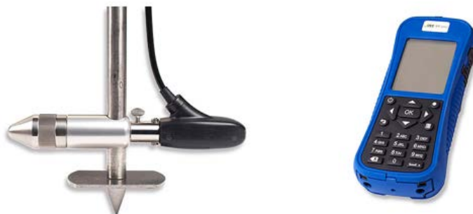
Abbildung 14: Strömungssonde (links) und das Mess- bzw. Bediengerät (rechts) (OTT Hydromet GmbH 2016)
