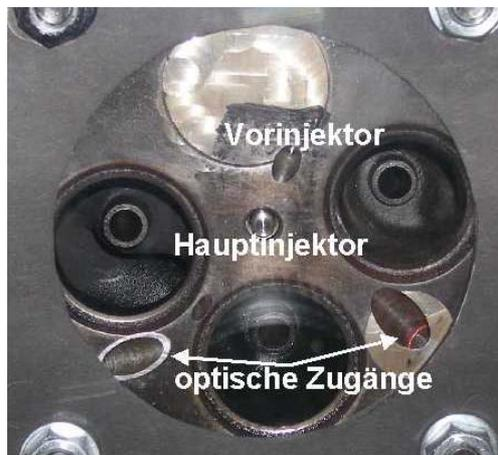
Abb. 10: Bearbeiteter Zylinderkopf
