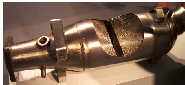
Abbildung 10: Aufgeschnittener Katalysator; deutlich zu erkennen ist die Wabenstruktur [WIKIPEDIA (I), 2010]
