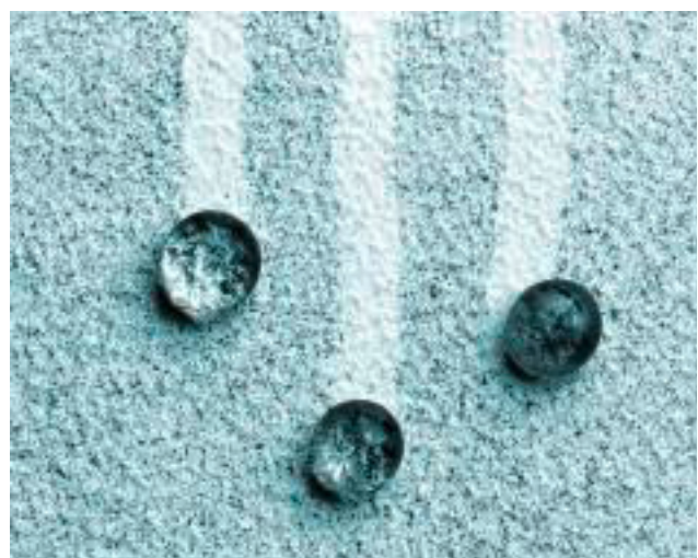
Abbildung 8: Selbstreinigende Fassade unter Nutzung des Lotus-Effektes [NEES-INSTITUT, 2010]
