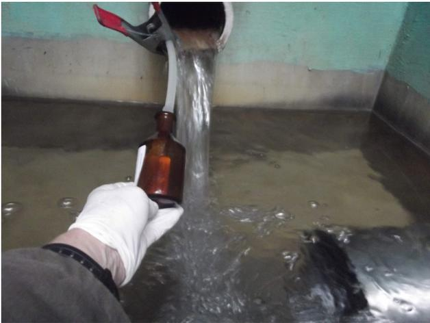
Abbildung 8-3: Befüllen einer Probenflasche im Quellschacht
