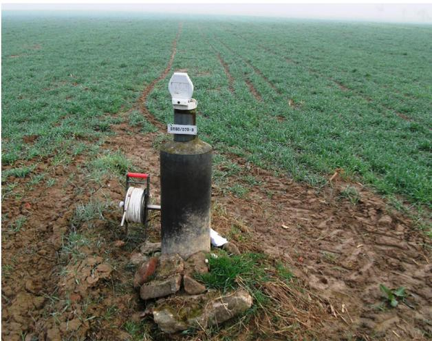
Überflur-Grundwassermessstelle mit Standrohr und Betonsockel
