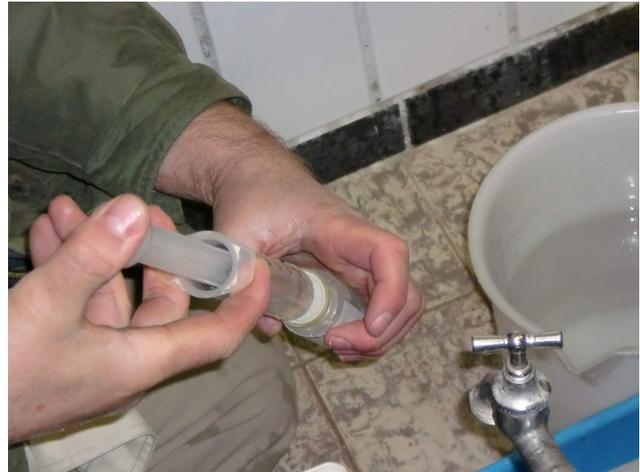
Abbildung 8-4: Handfiltration mit Mikrofilter
