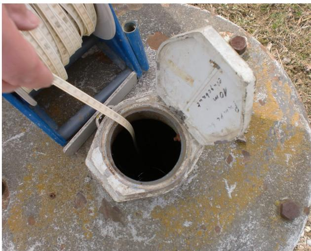
Abbildung 7-1: Messung des Grundwasserstands mit Lichtlot
