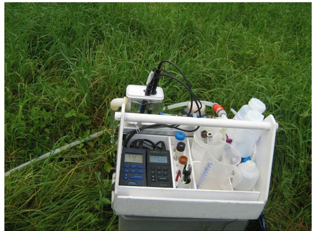
Abbildung 6-4: Verfolgen der Vor-Ort-Parameter beim Abpumpen
