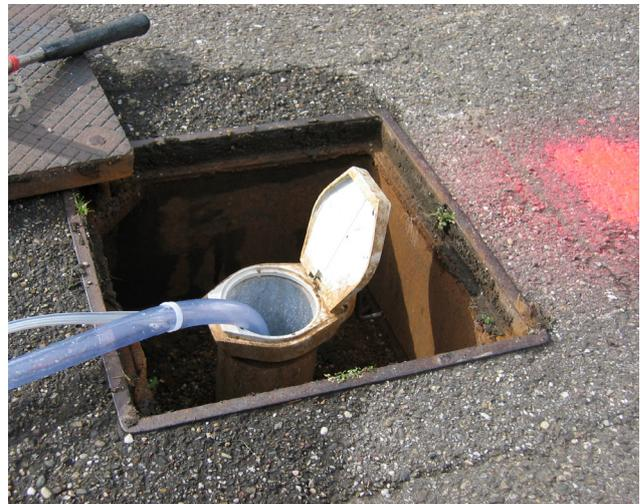
Abbildung 6-3: Probennahme an einer Unterflurmessstelle
