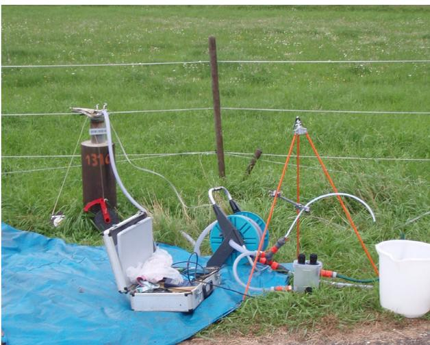
Abbildung 6-2: Probennahme an einem Grundwasserbeobachtungsrohr
