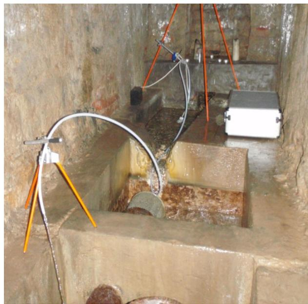
b) mit mobiler Pumpe von Quellsohle oder aus Becken
