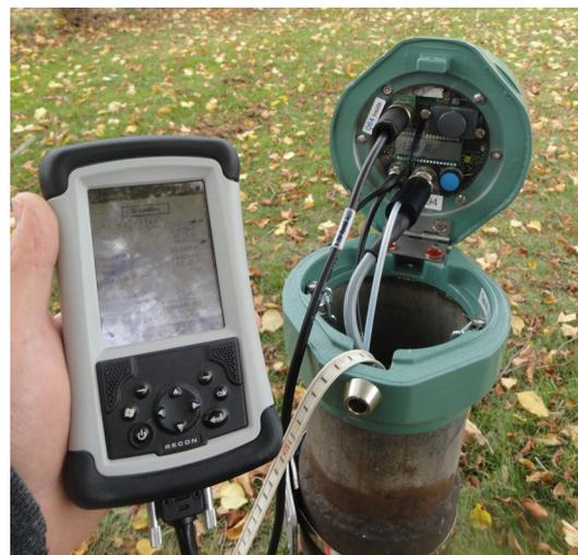
Abbildung 7-2: Datenlogger mit Auslesegerät
