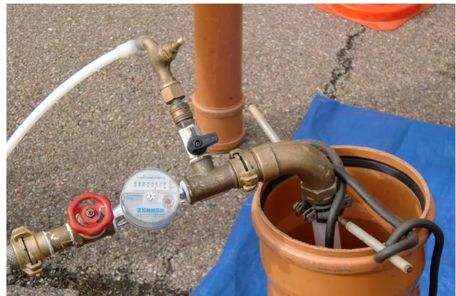
Abbildung 6-5: Messung der abgepumpten Wassermenge
