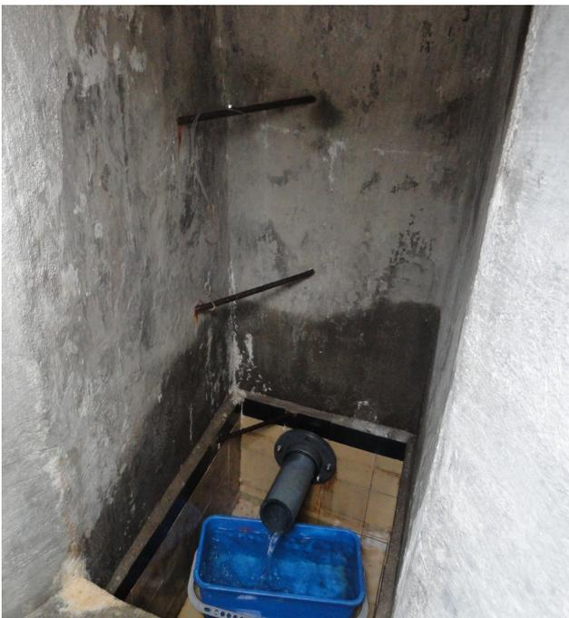
Abbildung 7-3: Messung der Quellschüttung - Eimermessung
