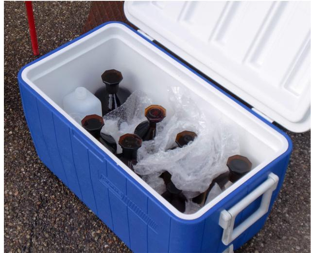
Abbildung 9-1: Stoßgesicherte Lagerung in Kühlbox
