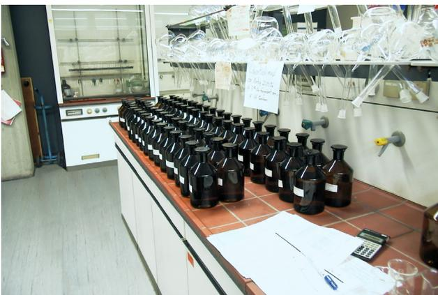
Abbildung 2-2: Vorbereitung der Flaschensätze für die vergleichende Untersuchung zwischen den teilnehmenden Laboratorien
