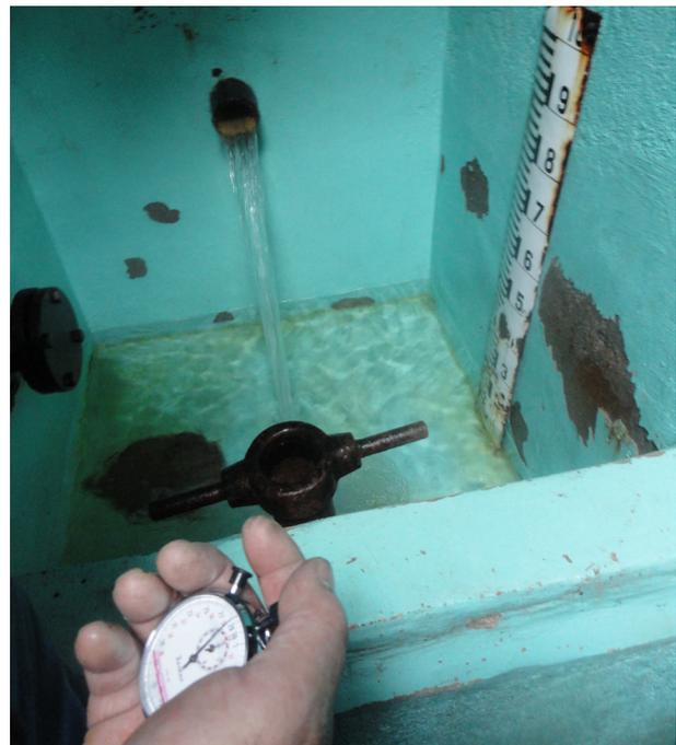
Abbildung 7-4: Messung der Quellschüttung - Beckenmessung
