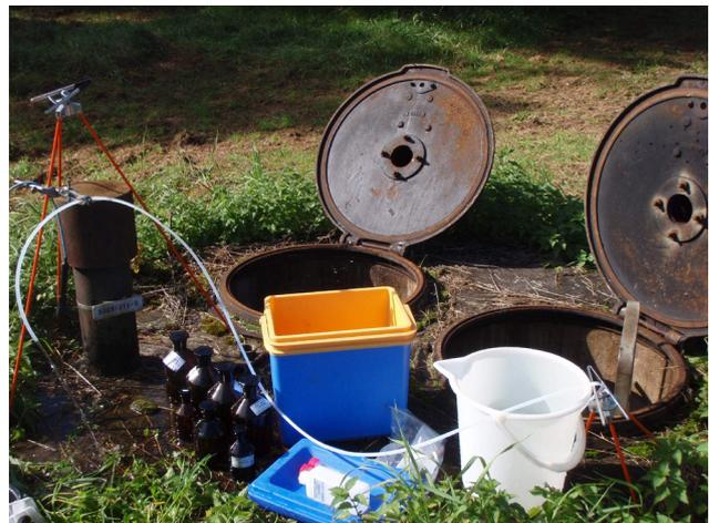
b) Teflonschlauch am Zapfhahn im Vorschacht
