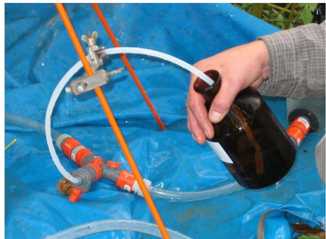
Abbildung 8-2: Befüllen einer Probenflasche mit Bypass
