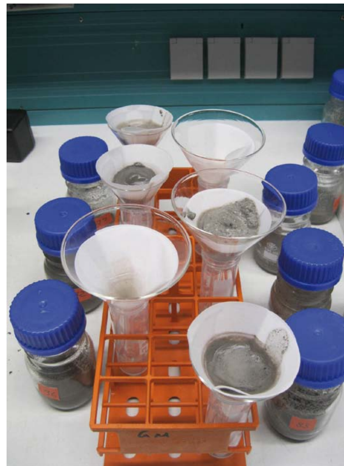
Bei niedrigem pH-Wert der Extraktionssäure kann es zu Verstopfung und zu Problemen beim Ernten der Laugungsflüssigkeit kommen. Bild: Universität Tübingen
