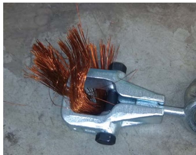
Ergebnis: Mit großem Kraftaufwand hat die Zugklemme die Stränge herausgezogen – und beinahe zerrissen.
