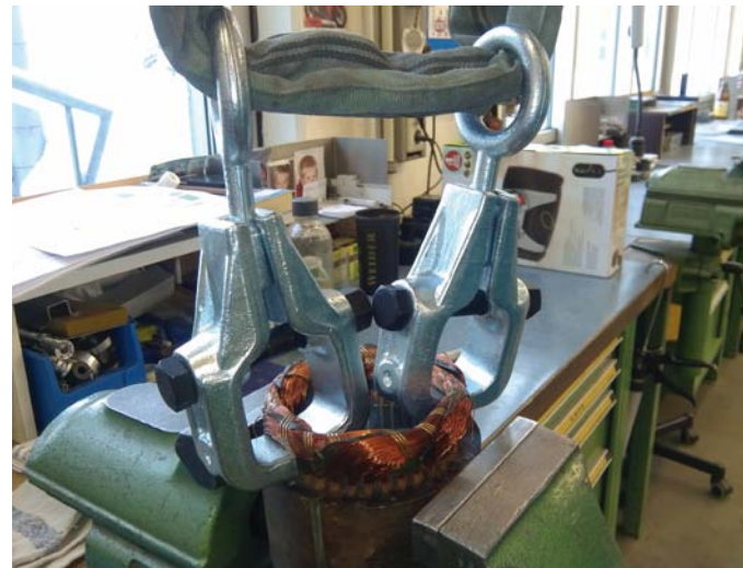
Versuchsaufbau: Karosserie-Zugklemmen werden an den Kupfersträngen befestigt.
