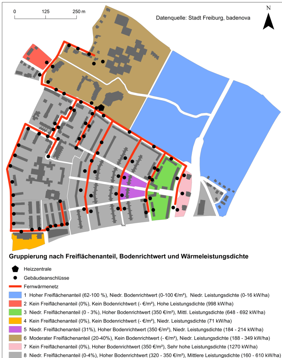
Abb. 19 Multikriterielle Gruppierungsanalyse des Stadtteils Freiburg Haslach zur Ermittlung des idealen Standortes für einen zentralen Wärmespeicher im Fernwärmenetz.
