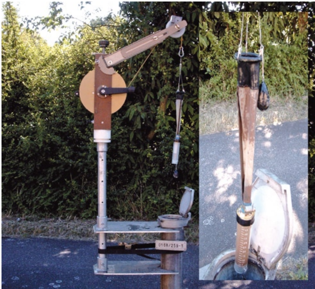
Abb. 9: Fangvorrichtung mit Seilwinde, Netz, Gewichten und Sammelgefäß.
