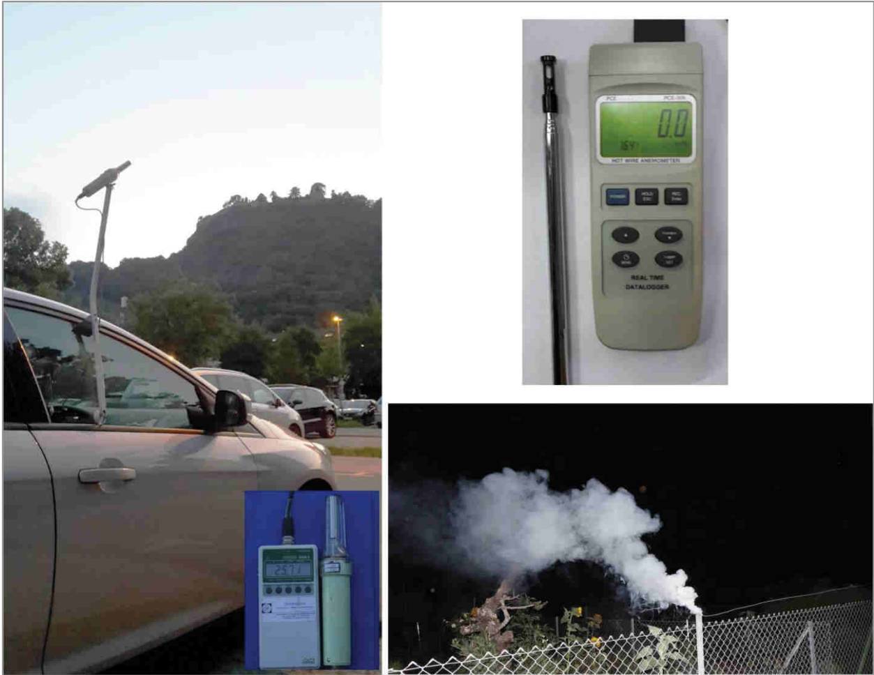
Abb. A 1: Fotografische Dokumentation: Messfahrzeug mit Psychrometer, Rauchschwadenbeobachtung und Windmessung mit einem Hitzdrahtanemometer (Fotoaufnahmen: ÖKOPLANA 2018)
