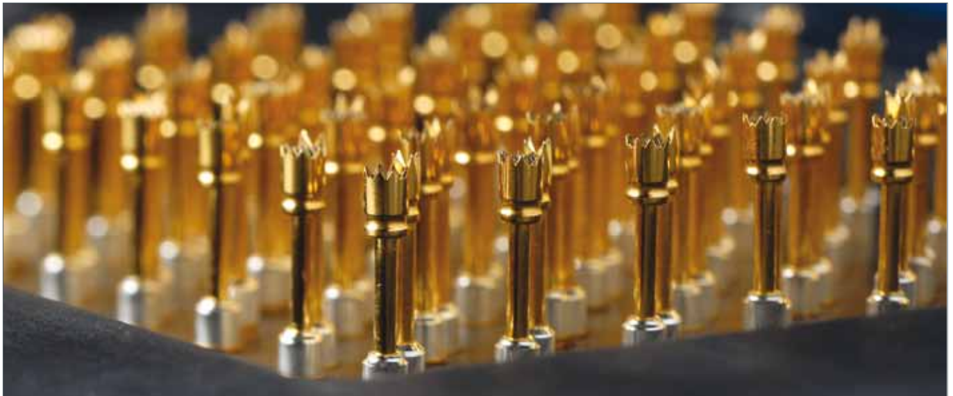
Detail der Hochtemperatur-PEM-Testzelle. Auch Goldstifte kamen dabei zum Einsatz.
