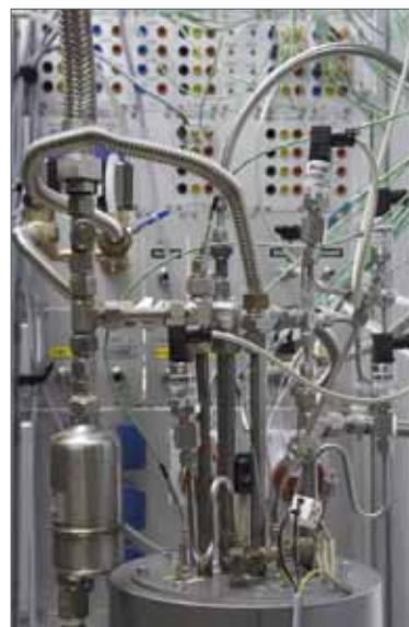
Hier wird der Reformier vor der Integration in das Gesamtsystem getestet. Bilder: ZSW
