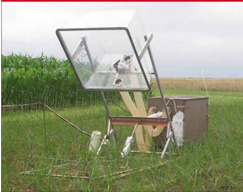
Zur Messung der Klimagase kommen die Miscanthuspflanzen sechsmal täglich unter die Haube
