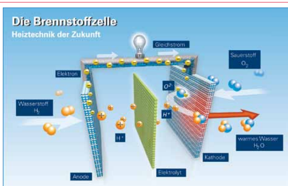
Strom und Wärme als Ergebnis der elektrochemischen Reaktion in einer Brennstoffzelle. Bild: Initiative Brennstoffzelle
