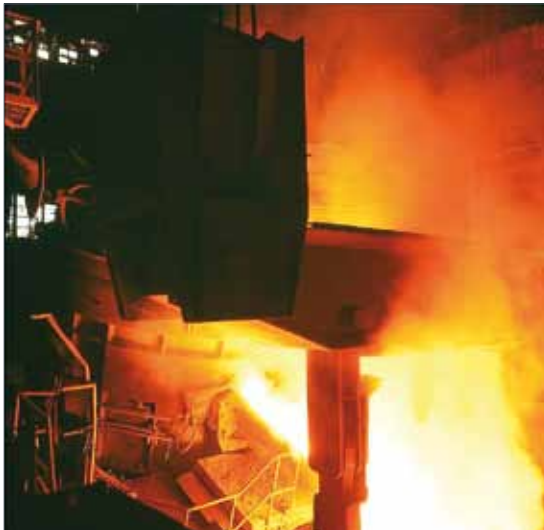
Lichtbogenofen in Gröditz mit stark schwankenden Abgas-Temperaturen Bild: Wikimedia/Dt, Fotothek
