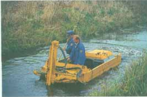
Abb. 42: Mähboote sind nur bedingt für die Entkrautung von Gräben geeignet. Es muss eine ausreichende Wassertiefe vorhanden sein. Häufig vorkommende Hindernisse wie z.B. Rohrdurchblässe machen den Einsatz unwirtschaftlich.
