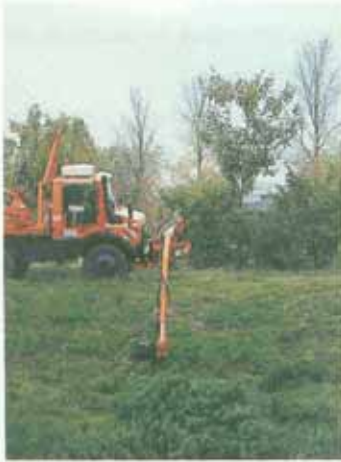
Abb. 35: Balkenmähergeräte sind sehr gut für die Mähd der Böschung und Uferstreifen geeignet. Bei sehr steilen Ufern sollten Mäher mit seitlich angebrachten Mähbalken verwendet werden. Außerdem gibt es Geräte, die an den Ausleger eines Trägerfahrzeuges montiert werden können.
