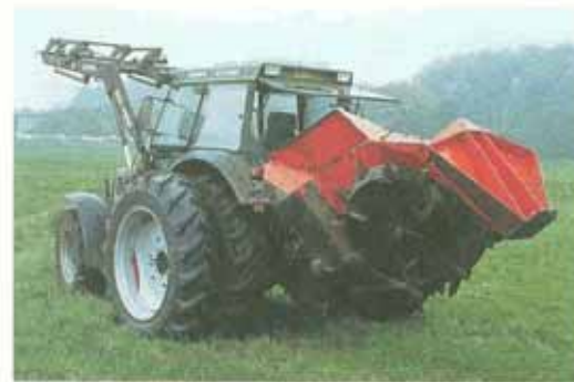
Abb. 45: Scheibenradfräse, an Schlepper angebaut. Das Trägergerät fährt beim Einsatz über dem Graben. Bei diesem Fräsentyp ist ein Betrieb mit langsamer Rotation der Scheiben möglich, sofern der Schlepper über genügend Motorleistung verfügt und kein bzw. wenig Wasser im Graben ist. Auf feuchten Böden ist die Doppel- oder Niederdruckbereifung des Trägergerätes wichtig zur Vermeidung von Schäden an der Grasnarbe.
