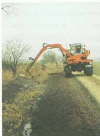
Abb. 41: Schlegelmäher (Schlegelhäcksler, -mulcher) im Einsatz. Hier wird das Gerät viel zu tief geführt, so dass es zu massiven Narbenschäden kommt.
