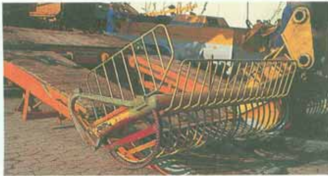
Abb. 39 und 40: Der Mähkorb kann für die Entkrautung und die Mahd der Uferböschung eingesetzt werden. Bei entsprechender Handhabung ist ein schonendes Arbeiten möglich. Abstandhalter, die an den Korb angeschweißt werden können, verhindern Narbenschäden an der Böschung bzw. Eindringen in den festen Untergrund der Grabensohle.
