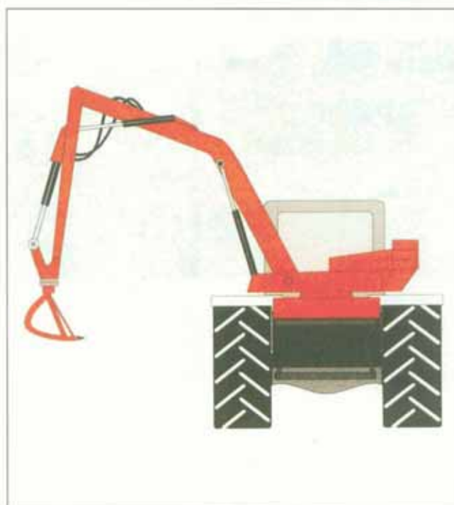
Abb. 38: Mähkorb an Auslegergerät auf Schlepper.
