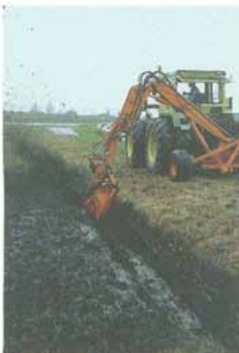
Abb. 46: Trommelfräsen arbeiten grundsätzlich mit hohen Drehzahlen. Dieses Gerät verfügt über einen eigenen Antrieb und wird vom Schlepper gezogen.
