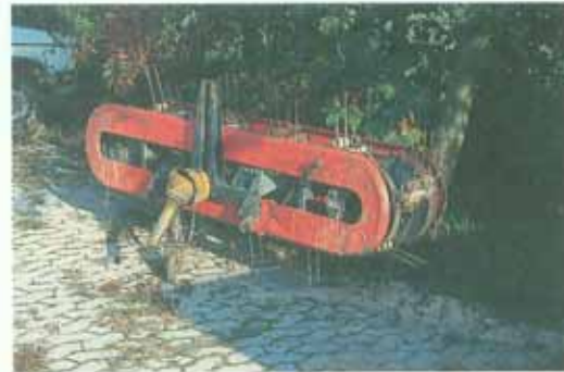
Abb. 43: Zum Abräumen des Mähgutes von den Uferböschungen eignen sich Band- und Kreiselschwader. Diese Geräte können auch in Kombination mit einem Balkenmähdwerk am selben Trägergerät betrieben werden.
