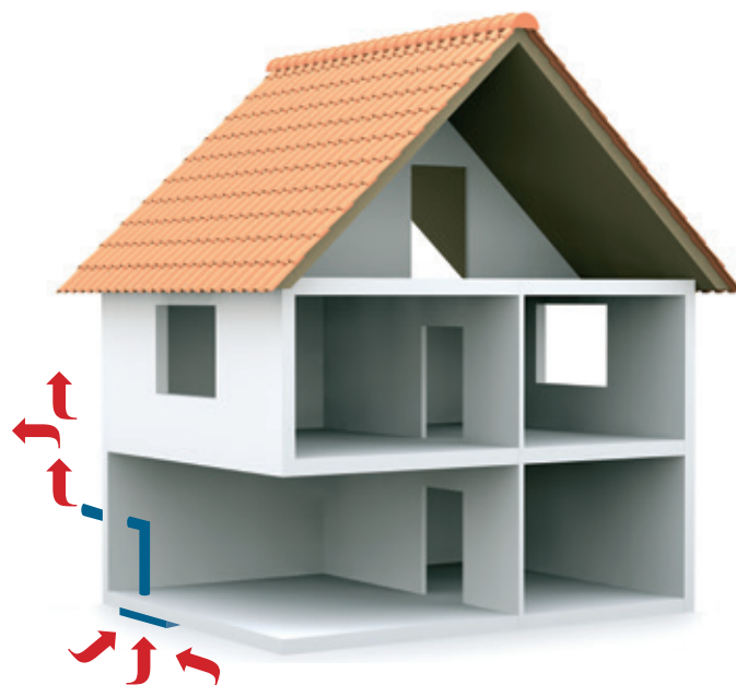
Schematische Darstellung eines Radonbrunnens
