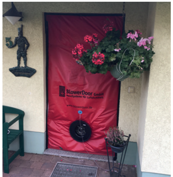
Blower-Door-Gerät zur Feststellung der Dichtheit eines Gebäudes
