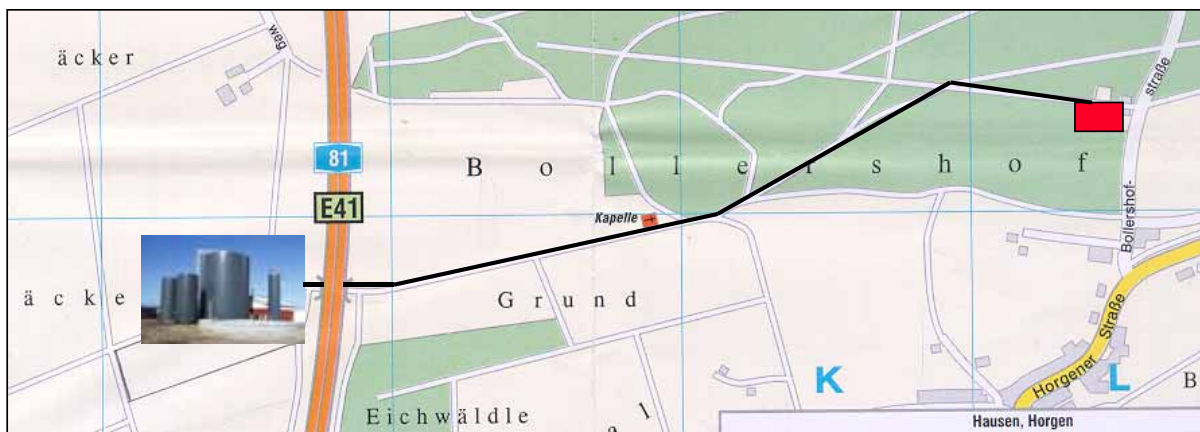
Abbildung C-7: Getrennte Biogaserzeugung: Transport des Biogases über eine Gasleitung zur Heizzentrale
