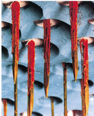
Abb. 4: Die Kunstfasern werden mit feinen, strukturierten Nadeln verfilzt
