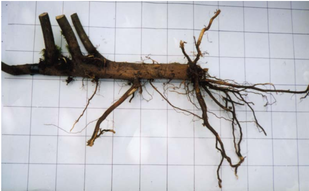
Bild 17: Salix purpurea aus einer 6-jährigen Buschlage (Deponie Hasenholz, Tuttlingen). Links die oberirdische Seite mit den gekappten Trieben. In der Mitte des Aststücks eine stärker nach unten gerichtete Wurzel. Rechts, am basalen Ende, ein ganzer Wurzelzopf mit überwiegend stärkeren Wurzeln (Basisdurchmesser > 10 mm). Vor allem die in Verlängerung des Aststücks in den Hang gewachsenen Wurzeln tragen durch ihre Ankerwirkung maßgeblich zu einer erhöhten Standsicherheit bei.
