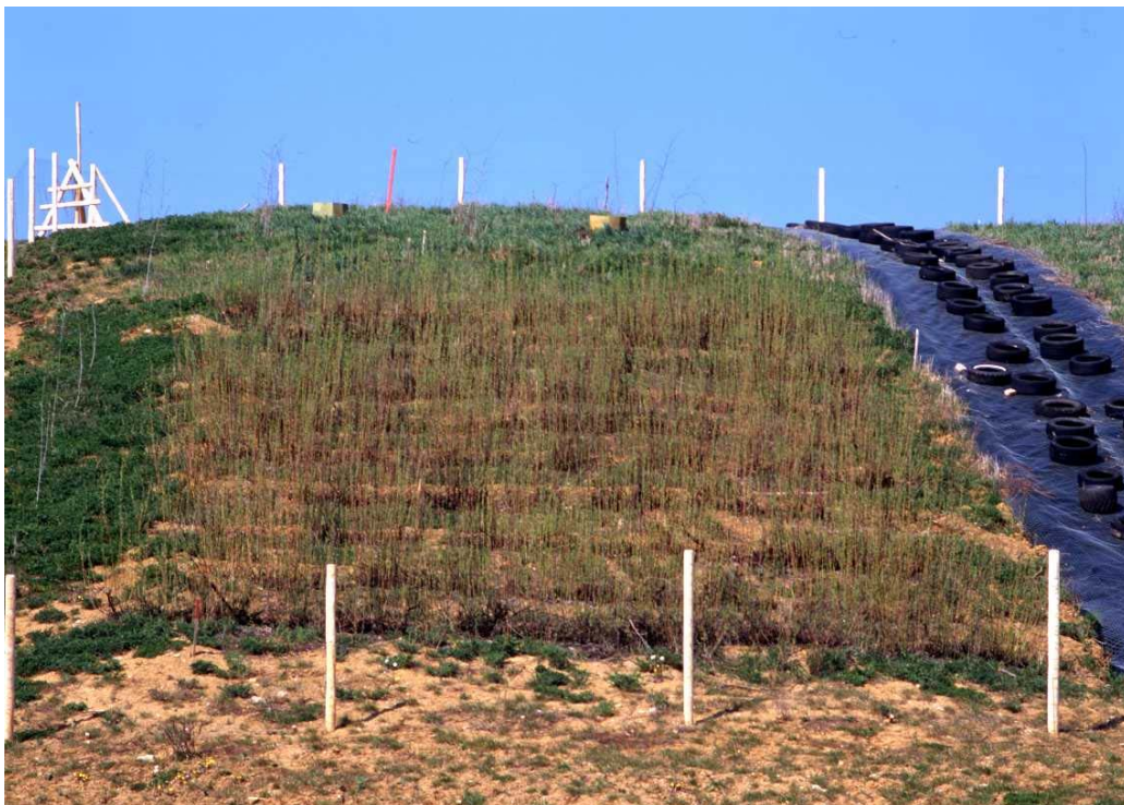
Bild 22 Testfeld mit Buschlagen zum Beginn des Laubaustriebs im Frühjahr 2002. Die Triebe aus dem Vorjahr haben eine durchschnittliche Höhe von 80 cm erreicht. Im ausgewachsenen Zustand sind ca. 3 – 5 m zu erwarten.
