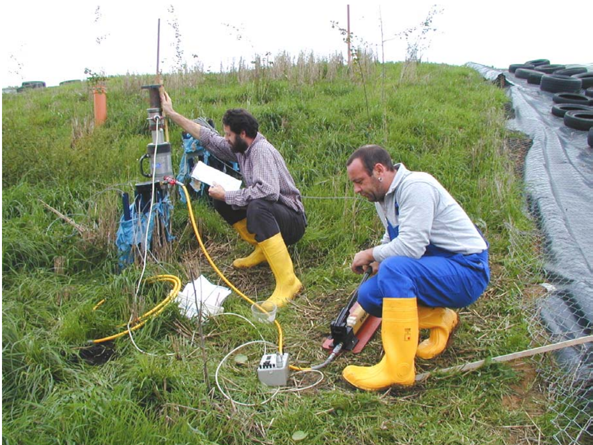
Bild 8: Durchführung eines in-situ-Scherversuches mit einem Karlsruher Schertester
