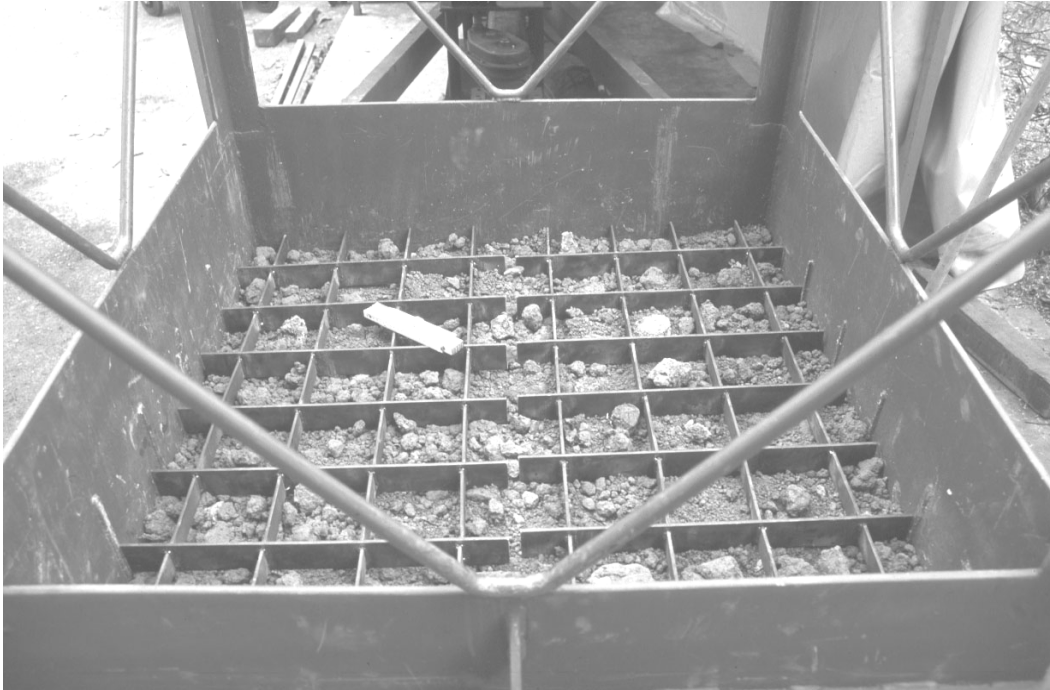
Bild 5: Blick in die Scherbox des Rahmenschergerätes mit dem zusätzlich eingelegten Gitterrahmen zur flächigen Schubkrafteinleitung in die obere Probenhälfte (Probe noch nicht fertig eingebaut)
