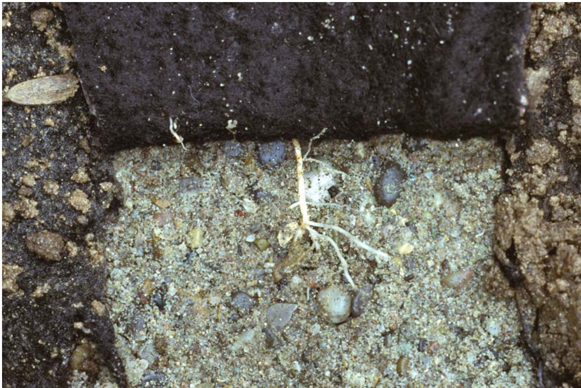
Bild 24: Eine Ampferwurzel hat die Kupfer-Wurzelspermmatte durchdrungen; die Matte ist aufgeschnitten, Ansicht von unten
