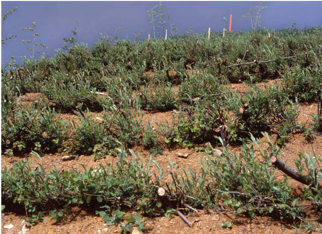
Bild 21: Erste Triebbildung an den im vorangegangenen Dezember im Testfeld eingebauten Buschlagen im Mai 2001. Der Anwuchs erfolgte sehr gleichmäßig und ohne große Lücken. Eine wichtige Voraussetzung für den Erfolg der Maßnahme.
