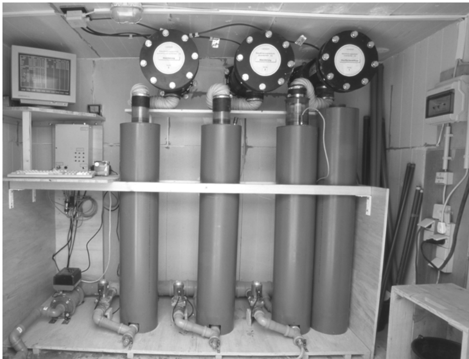
Bild 13: Anlage zur Messung der Abflüsse aus den Lysimeterfeldern
