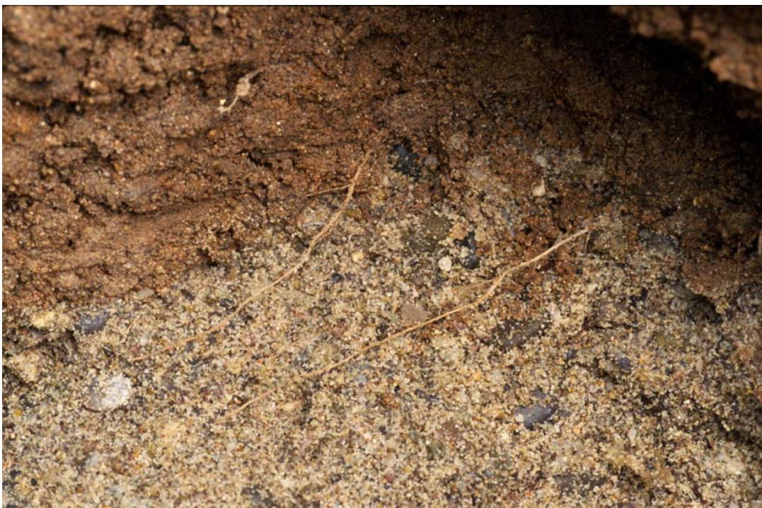
Bild 26: Wurzeln werden vom verdichteten Sand in horizontale Wuchsrichtung abgelenkt.
