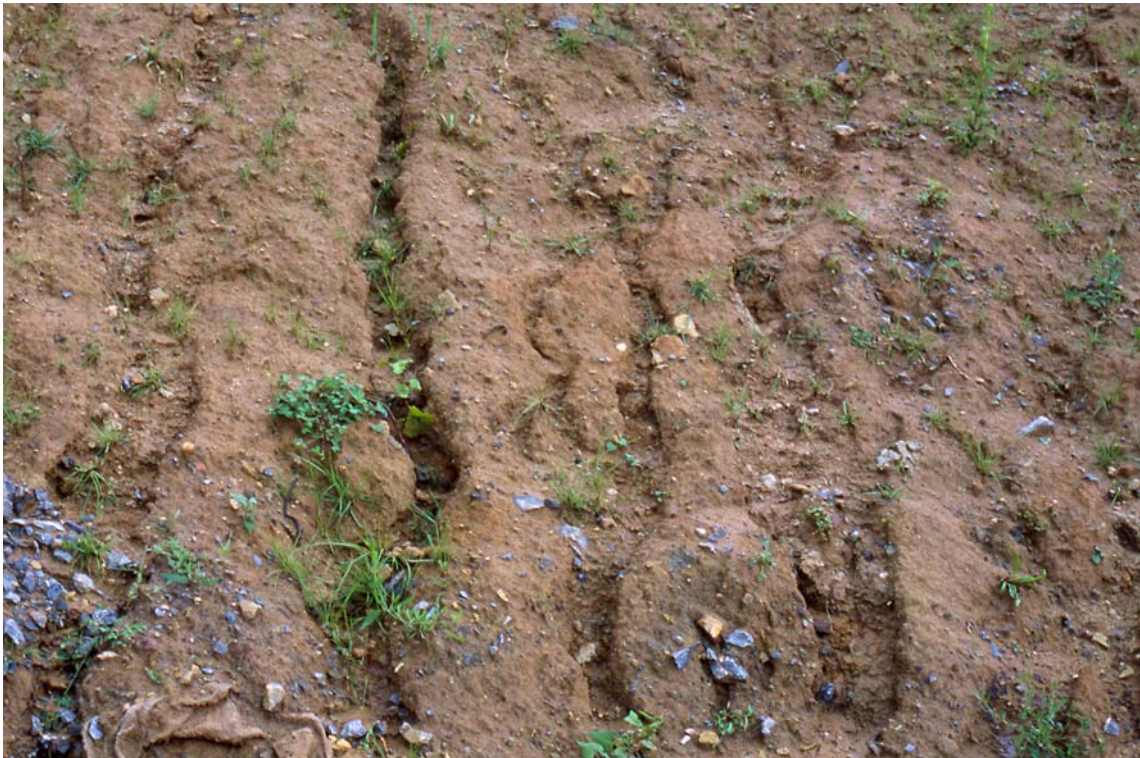
Bild 12: Im Gegensatz dazu tritt auf eingeebneten Flächen in der Umgebung der Testfelder deutliche Rillenerosion auf.
