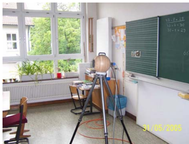
Abbildung 3: Lautsprecher zur Messung der Raumimpulsantwort auf Position 1.
