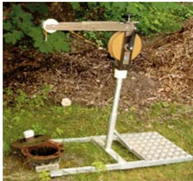
Abb. 15: Für die Probennahme verwendete Seilwinde und Halterungskonstruktionen.
