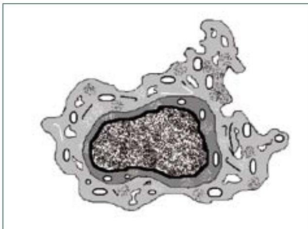
Abbildung 6: Schematische Darstellung des Biofilms an einem Sedimentpartikel. Die unterschiedlichen Grautöne zeigen die Schichten, in denen Sauerstoff verfügbar ist (hellgrau) bzw. die sauerstofffrei sind (dunkelgrau). Bakterien und Mikroben sind als Kreise oder Stäbchen dargestellt.
