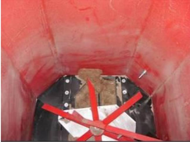
**Abbildung 22: M99: Agglomeration zwischen Gehäusewand und Rührwerk führen zum Blockieren des Rührwerks**
