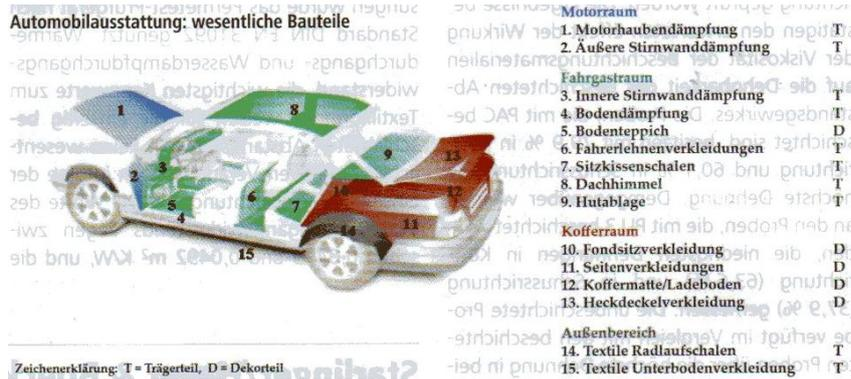
**Abbildung 65: Anwendungen Faserformteile im Kfz**
