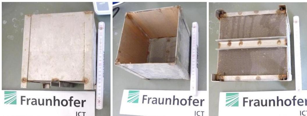
**Abbildung 44: Kleiner Siebkasten (150 mm x 150 mm x 150 mm)**
