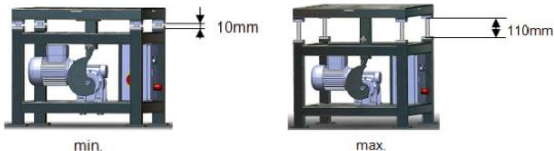
**Abbildung 11: Änderung der Prüflast durch Variation der Fallhöhe**
