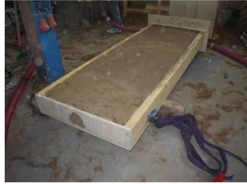
**Abbildung 17: Sehr gutes Ergebnis mit modifiziertem (gesiebttem) Material**
