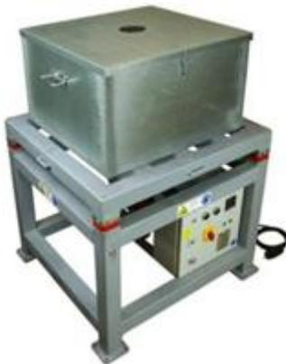
**Abbildung 10: Setzungsprüfstand in Anlehnung an ISO/TC 163/SC 1 N 354 E**
