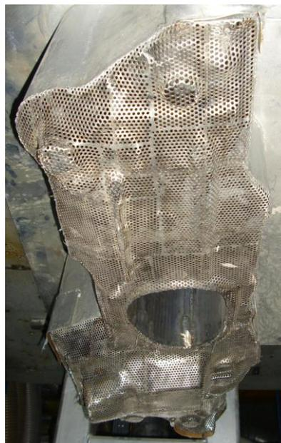
**Abbildung 67: Press-Oberwerkzeug**
