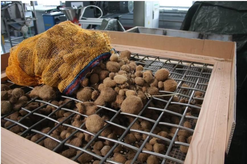
**Abbildung 3: gefertigtes Sieb der Maschenweite 63 mm**
