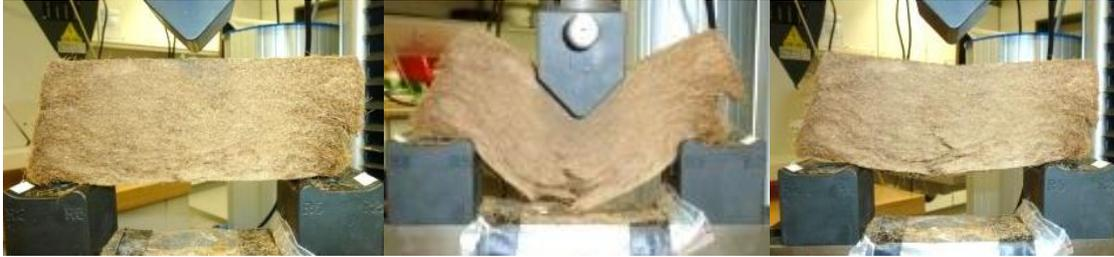
**Abbildung 80: Bilder Biegeversuch Binder E 14 Gew.-%**
