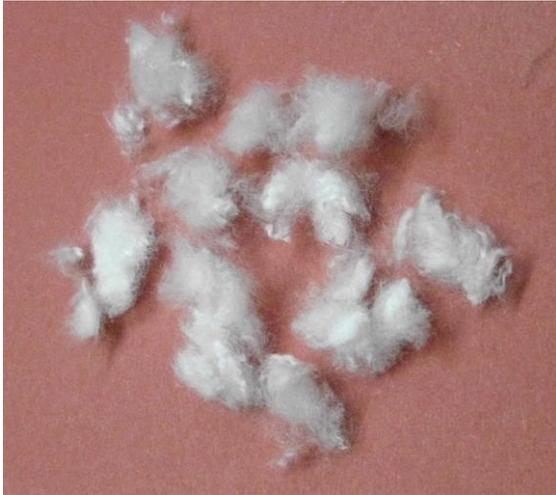
**Abbildung 58: Bicofaser kurz, 12mm**
