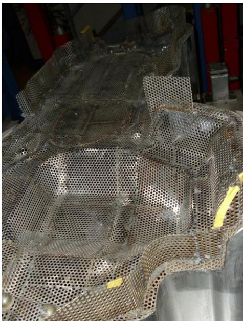
**Abbildung 66: Press-Unterwerkzeug**
