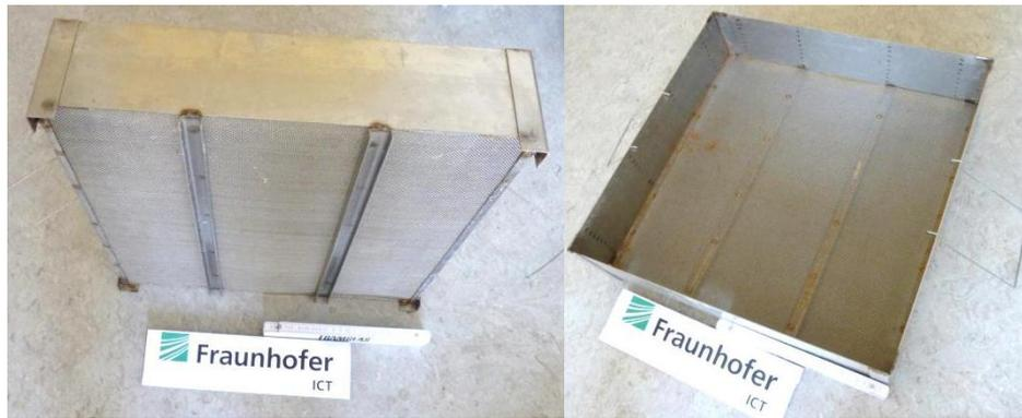
**Abbildung 42: Großer Siebkasten (450 mm x 450 mm x 100 mm)**
