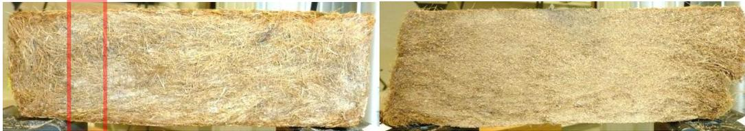
**Abbildung 50: Matten mit 14 Gew.-% A aus dem Trockenschrank (links) und 14 Gew.-% E aus der Mikrowellenanlage (rechts)**
