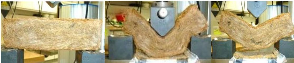
**Abbildung 81: Bilder Biegeversuch Binder A 14 Gew.-%**
