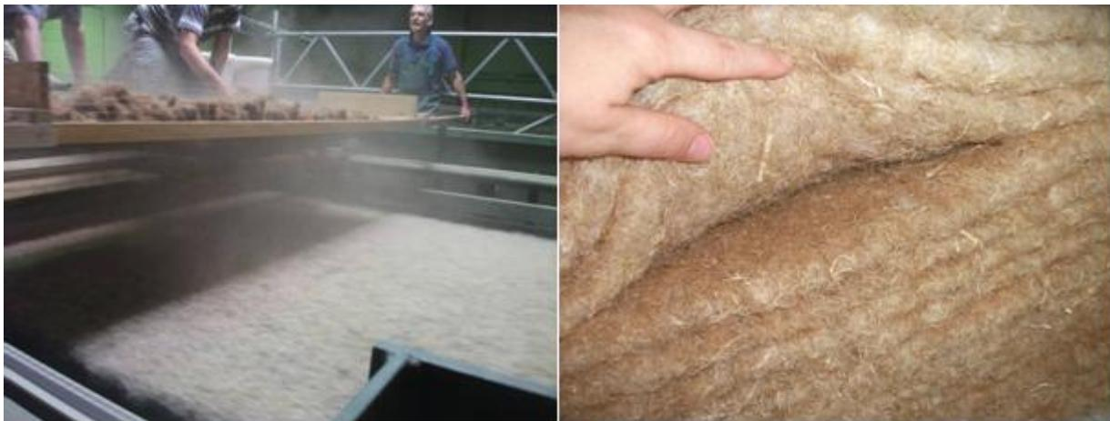
**Abbildung 53: Versuchsanordnung 1 zur Verbundmattenherstellung und gelegte Matte nach dem Kreuzleger**
