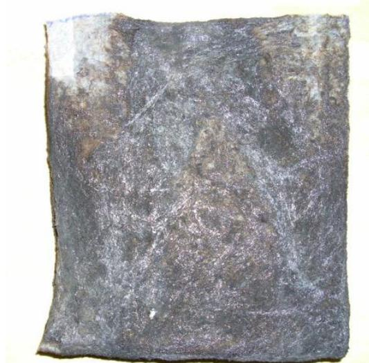
**Abbildung 62: Brennprobe nach TL1010 (VW)**
