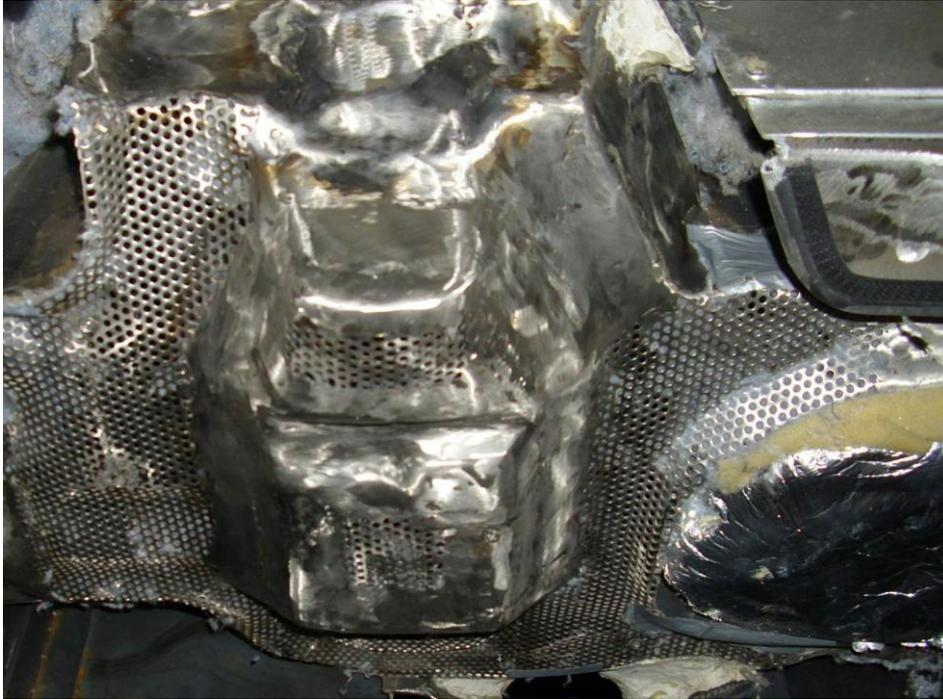
**Abbildung 68: Einblas-Oberwerkzeug**
