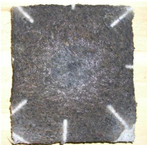
**Abbildung 63: Musterplatte nach intensiver Beflammung**
