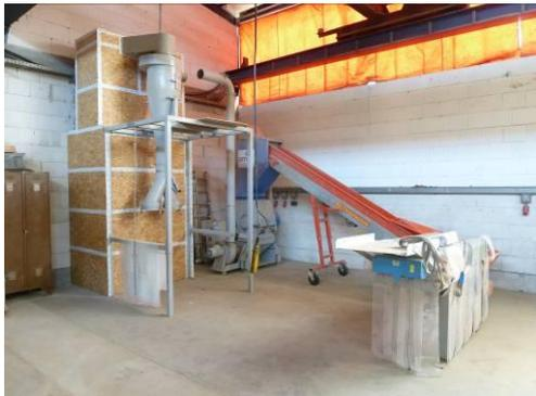
**Abbildung 14: neue Anordnung mit Staubschutz- Einhausung**
