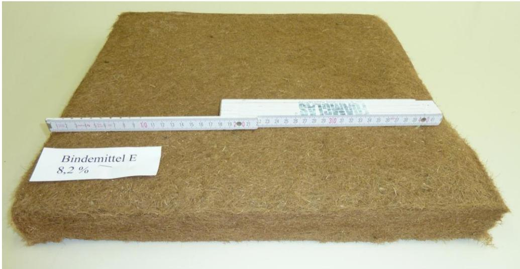
**Abbildung 82: Matte (eingeblassen und ohne Druck hergestellt)**
