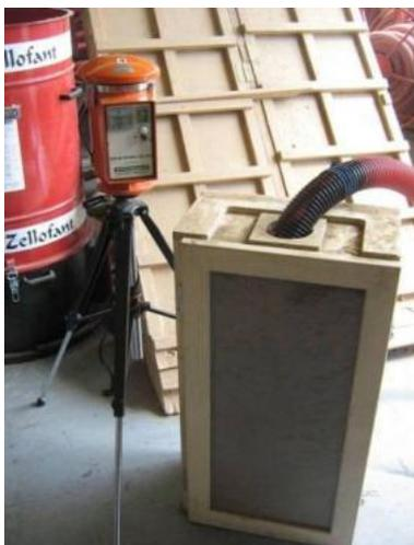
**Abbildung 9: Staubmessung mit Staubsammelgerät vom Typ Gravicon**
