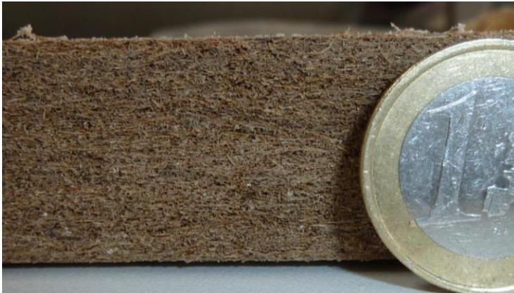
**Abbildung 51: Schnittkante einer gepressten Posidonia-Platte mit Binder E**
