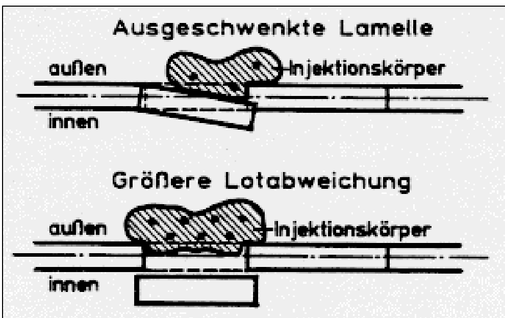
Abb. 5.2 Schematische Darstellung von Nachbesserungen mittels der Injektionstechnik (DONEL 1985)
