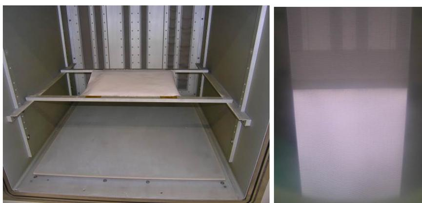
**Abbildung 11: Links: Provisorischer Versuchsaufbau zur Beschichtung von Membranen. Rechts: Plasma im Betrieb.**
