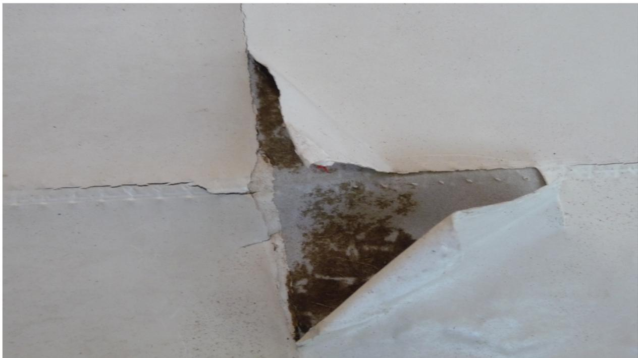
**Abbildung 39: Delamination nahe einer Schweißnaht.**
