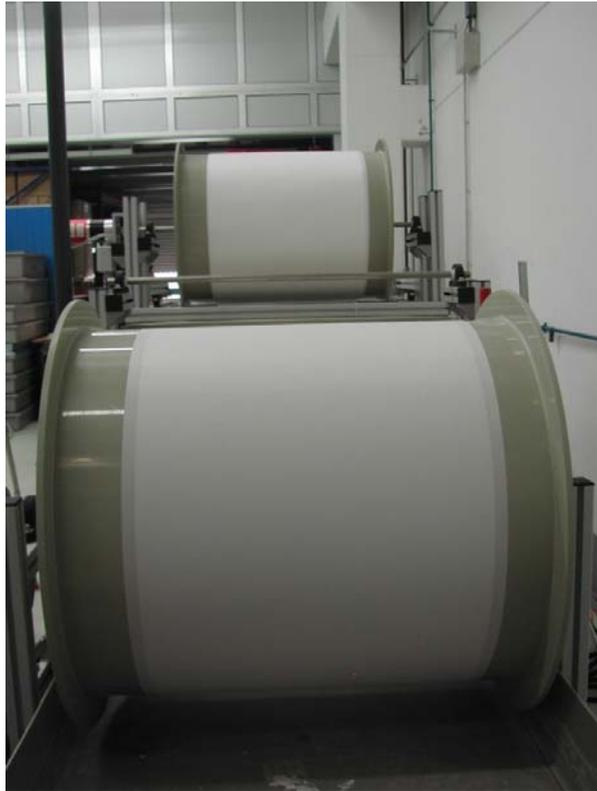
**Abbildung 36: Aufwickelrollen Flachmembranziehanlage.**
