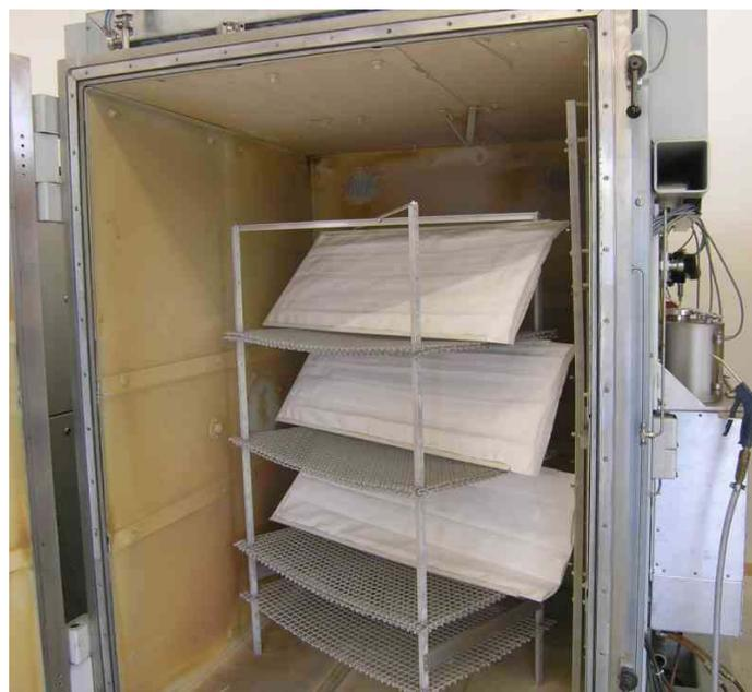
**Abbildung 37: Porta300-Anlage zur Beschichtung der kompletten Kissen.**
