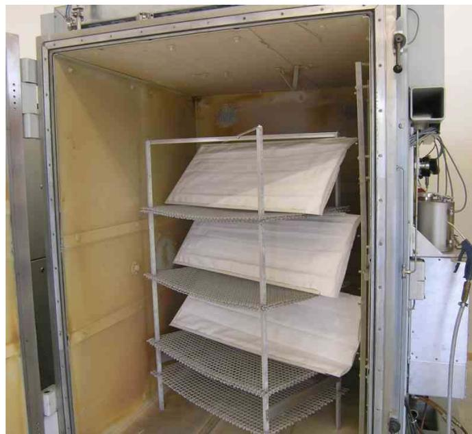
**Abbildung 29: Porta300-Anlage zur Beschichtung der kompletten Kissen.**
