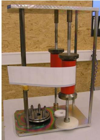
**Abbildung 22: Versuchsaufbau zur Plasmabeschichtung von Membranmaterial.**
