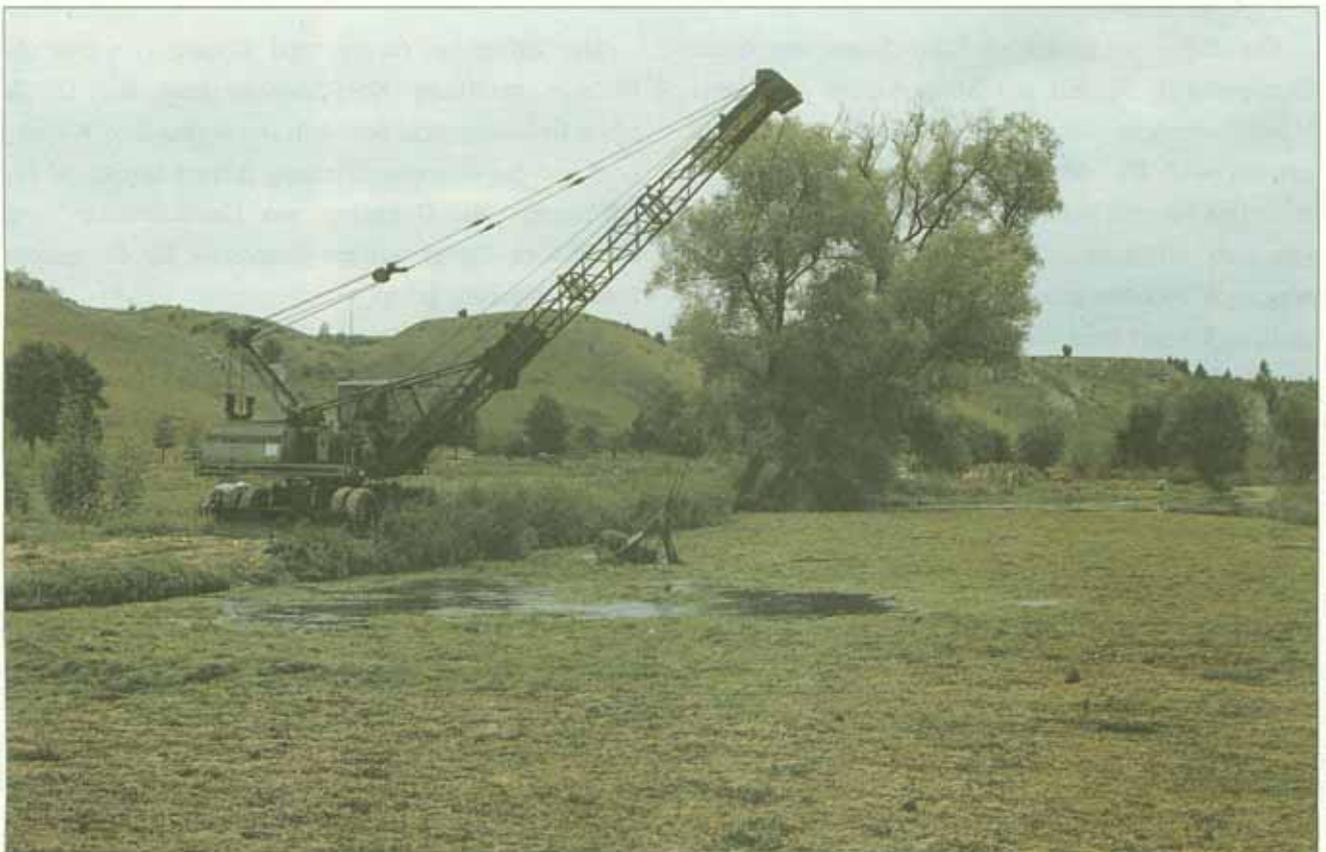
Abb. 5: Mähgutentnahme mit Seilzugbagger
