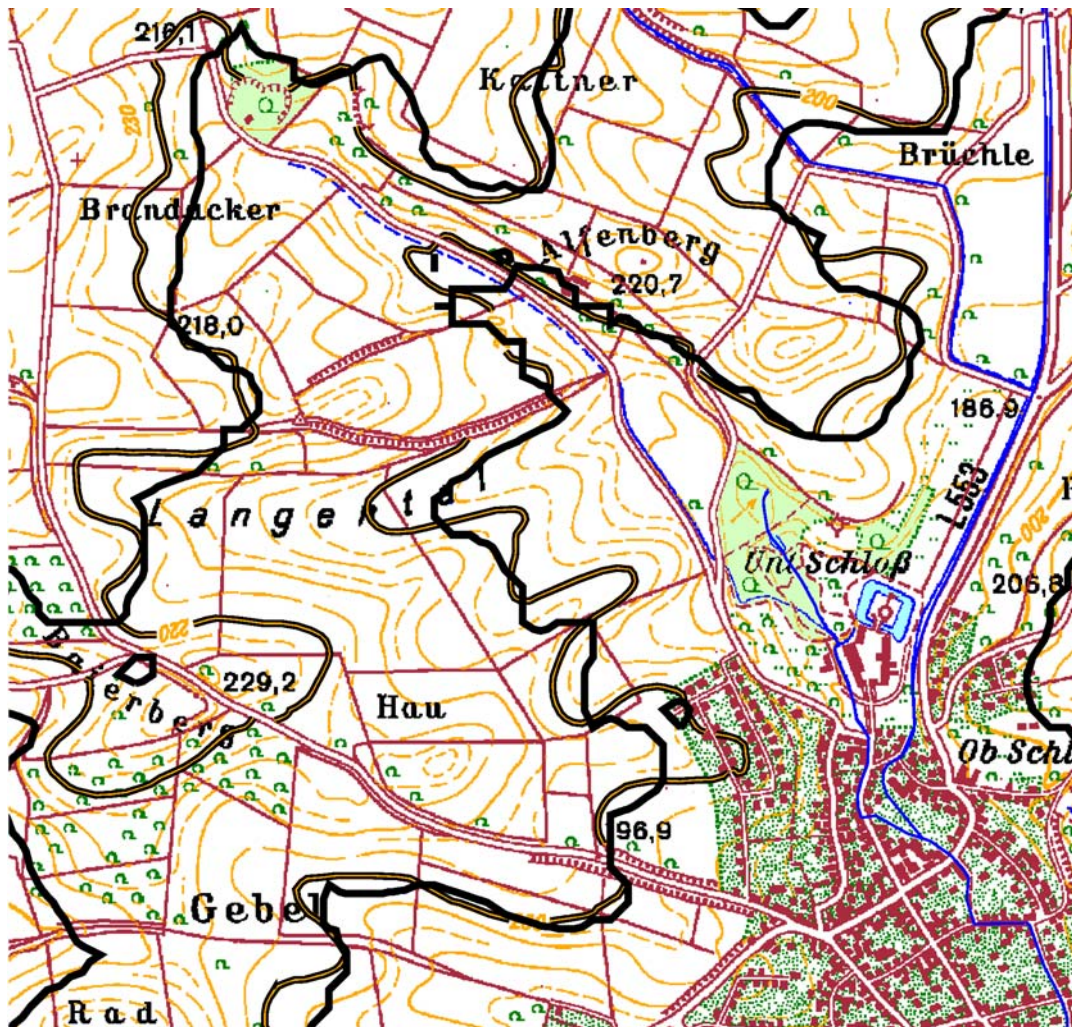
Abbildung 10-4: Die aus dem Digitalen Höhenmodell berechneten Höhenlinien (schwarze, breite Striche, Höhe 200 und 220 über NN) unterlegt mit der TK 25 (entsprechende Höhenlinien hervorgehoben), Detailansicht des Testgebietes
