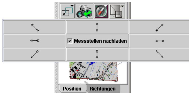
Abbildung 4.1: Menü zum Nachladen von Gelände und neuen Messstellen im Übersichtsfenster
