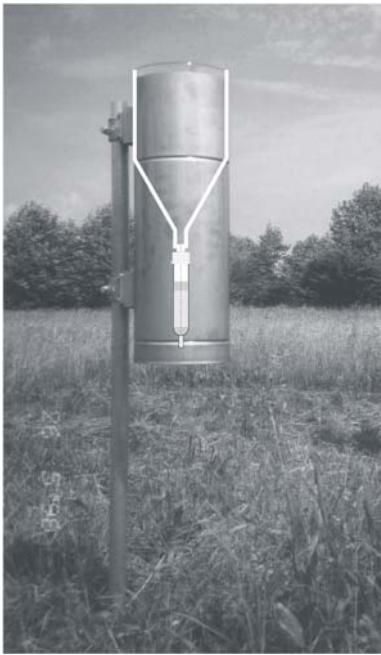
Abbildung 2-5 Depositionssammler im Gelände mit skizzierten Trichter und Adsorberkartusche (veränderte Abbildung der Fa. UMEG).
