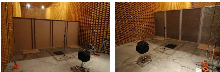
Abb. 29: Lärmschutzwand ohne (links) und mit MPA-Absorber (rechts).
