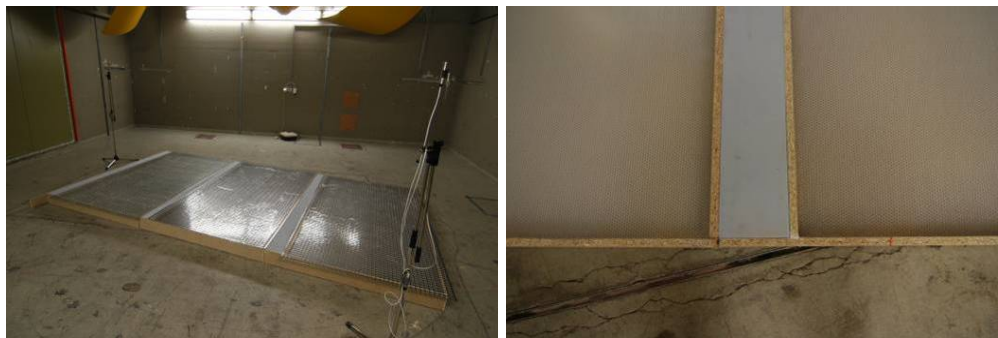
Abb. 24: Hallraumaufbau mit Pfosten aus porösem Material.
