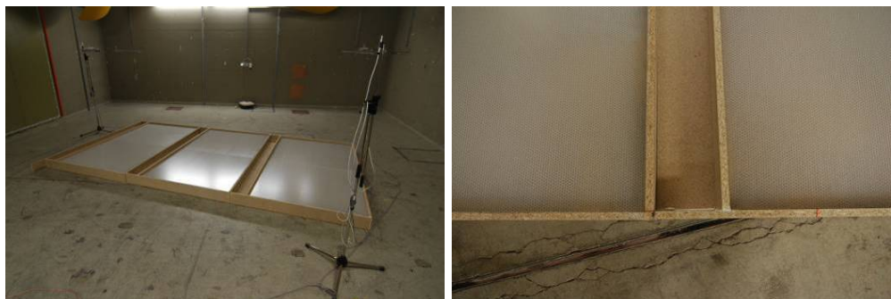
Abb. 25: Hallraumaufbau mit freien (nicht ausgelegten) Pfosten.
