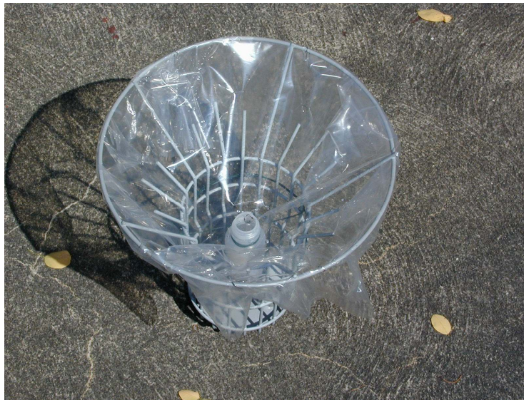
Abb. 5: Vorrichtung zur Beprobung des Straßenabflusses im Gully
