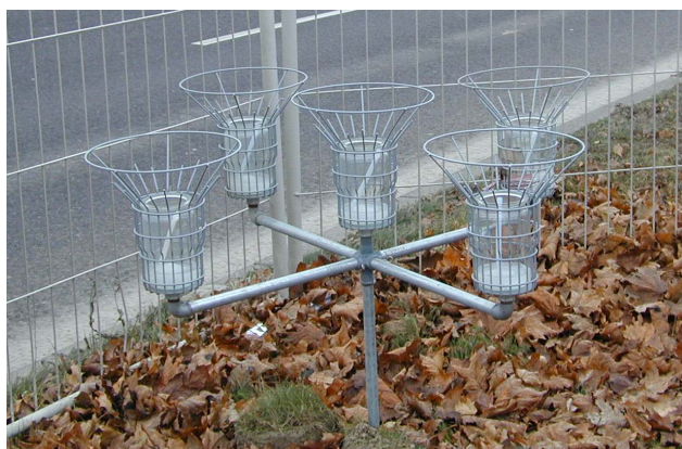
Abb. 3: Probennahmegeräte und -standort an verkehrsreicher, innerstädtischer Straße
