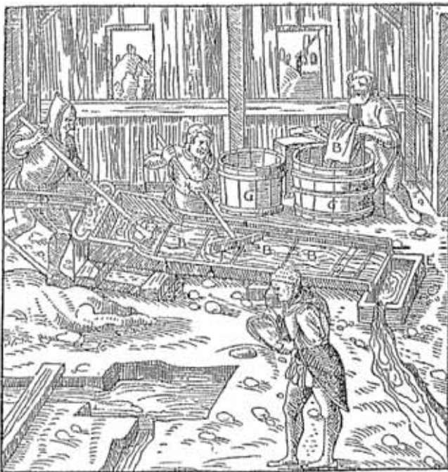
Abbildung 1: Waschen der Erze aus Agricola, 1556 (zitiert in Goldenberg, 1993).
