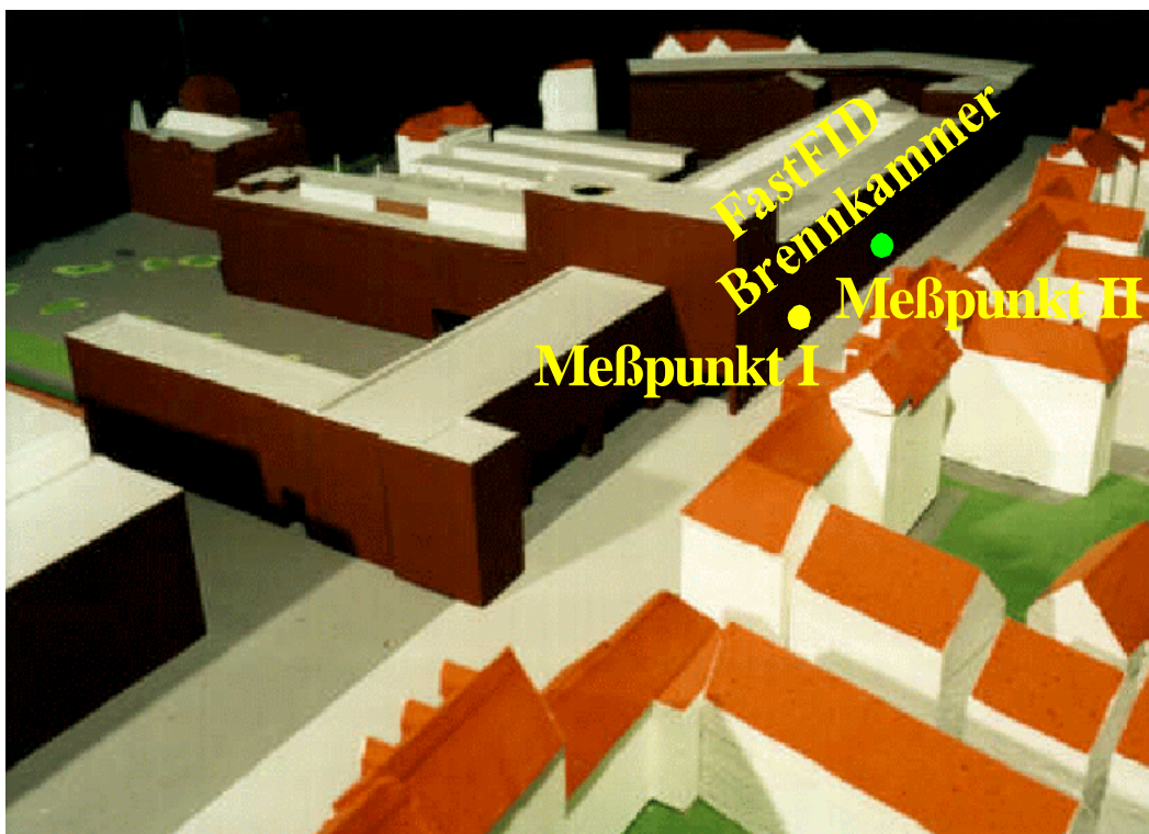
Abb. A.5: Detailliertes Modell (Maßstab 1:200) der Göttinger Straße im Mehrschichten Windkanal
