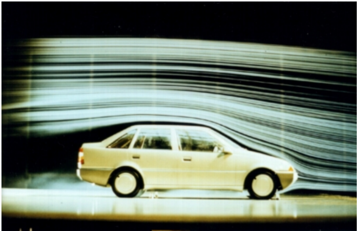
Abb. 6.11: Sichtbarmachung des Strömungsfeldes um einen Pkw durch Rauchzugabe
