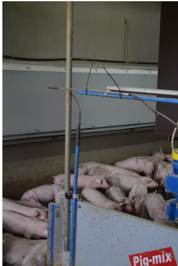
Abbildung 4: Messsonde im Tierbereich bei Aufzuchtferkeln mit 15 kg Körpergewicht
