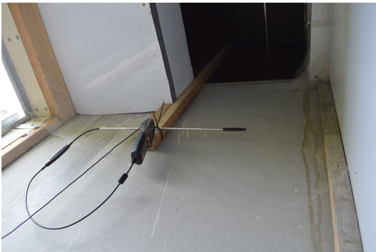
Abbildung 2: Temperatur-, Luftfeuchte und Luftgeschwindigkeitsmessgerät "testo 435"
