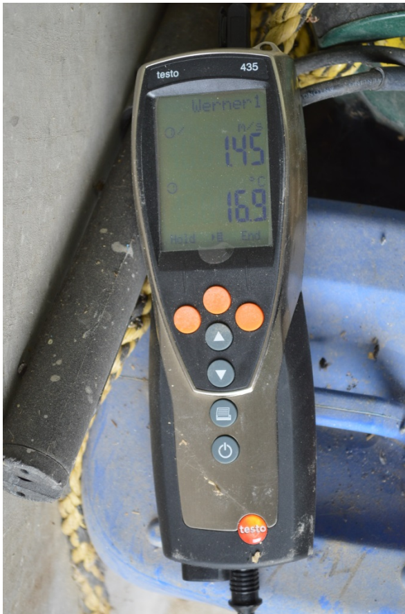
Abbildung 3: Display des Messgeräts „testo 435“ (Luftgeschwindigkeits- und Temperaturanzeige)
