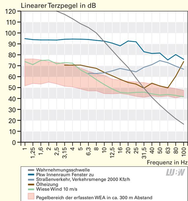
Vergleich der Geräusche innerhalb eines Pkw, an einer Straße, auf freiem Feld sowie einer Ölheizung mit dem Pegelbereich der gemessenen Windkraftanlagen sowie der Wahrnehmungsschwelle des Menschen
