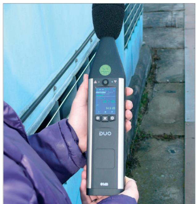
Abb.32: Modernes Schallpegelmessgerät
