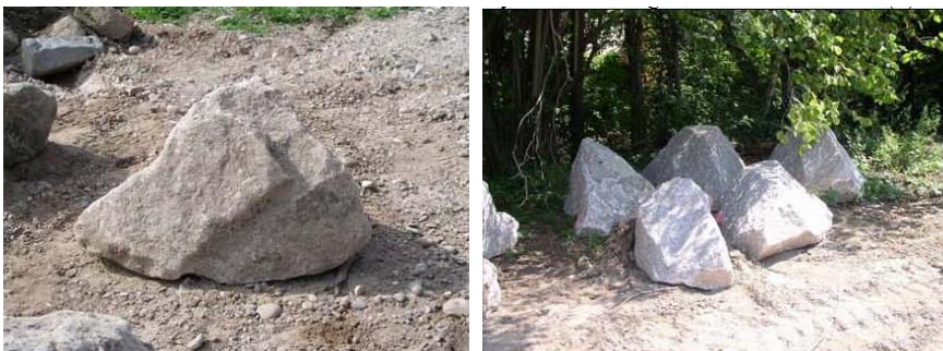
Bild 8: Geeignete Störsteine für den Einbau nach WIEGNER
