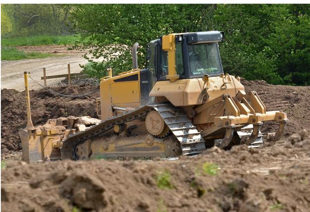
Abb. 9.2-3: Einsatz bodenschonender Bagger und Raupen mit breiten Kettenlaufwerken (Foto: Ritter)
