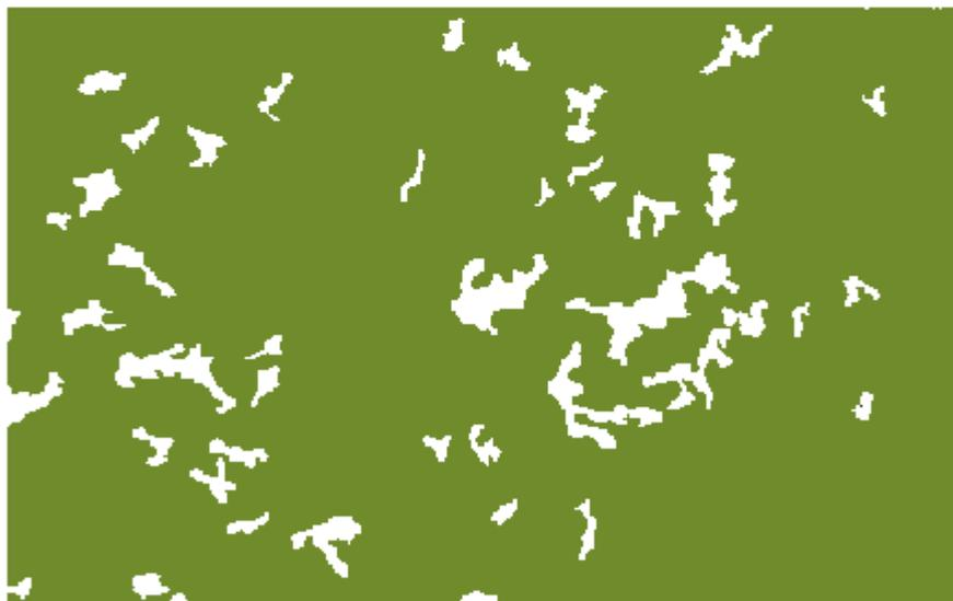
Der Anteil der für die Bodendurchlüftung besonders wichtigen größeren Hohlräume („Groporen“), in den Bildern als weiße Flächen dargestellt, wurde durch die Verdichtung erheblich reduziert.
