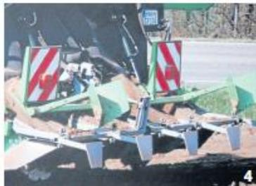
4 Die Spaten des Querdammhäufers sitzen auf einer Exzenterwelle und werden über einen Ölmotor angetrieben. | 5 Ulrich Bernhard zeigt auf die nach mehreren Regenfällen etwas abgeflachten Querdämme.
