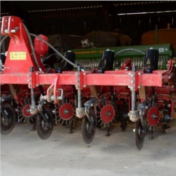
Abbildung 64: Prototyp Streifenlockerer (Renningen-Ihinger Hof)
