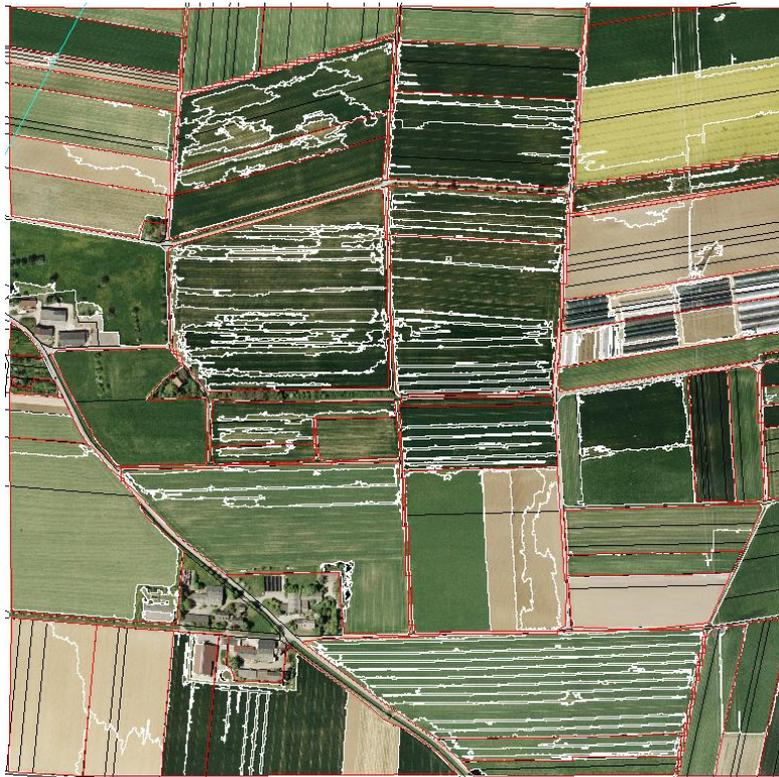
Abbildung 12: Ergebnis der Aggregation von kleineren Flurstücken (schwarze Linien) zu größeren Bewirtschaftungseinheiten nach (i) Luftbildsegmentierung (weiße Linien; n. Klett 2015, pers. Mitt.) und (ii) anschließender Objekttaggregation mit Zonenstatistik (rote Linien) am Beispiel der Luftbildkachel 34995411 vom TEZG Aischbach in Korntal-Münchingen. Manuelle Nachkorrekturen sind aufgrund visueller Endprüfung ggf. noch erforderlich.
