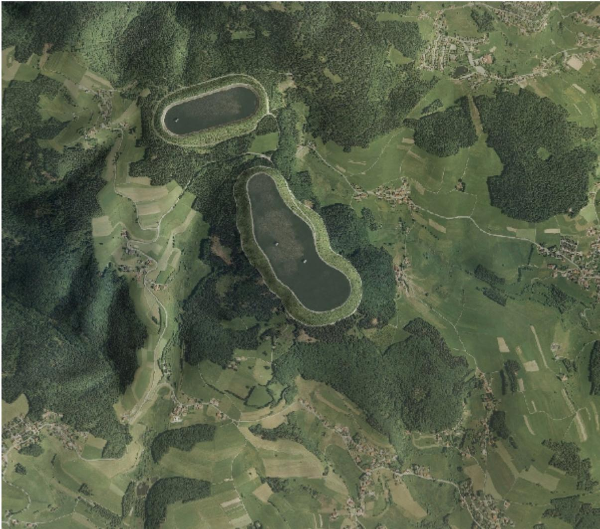
Die Visualisierung zeigt das geplante Oberbecken (Hornbergbecken II) mit einem geplanten Volumen von 9 Mio. m<sup>3</sup> südlich des bereits bestehenden Hornbergbeckens I ([www.schluchseewerk.de/index.php?id=275](http://www.schluchseewerk.de/index.php?id=275))
