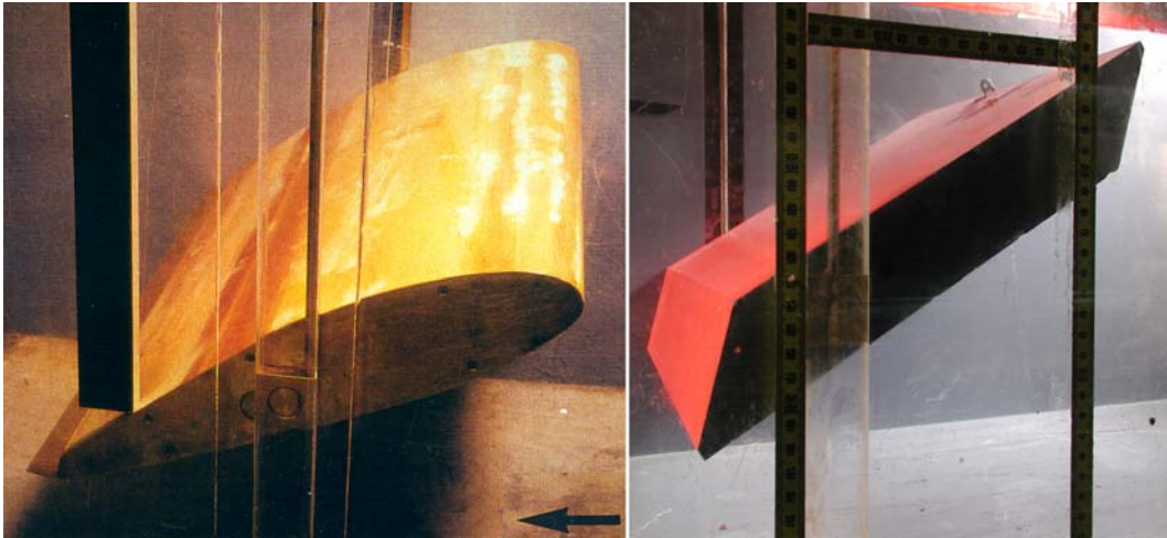
Abbildung 4.7: Entwicklung der Klappengeometrie (links: Studie 1998, rechts: Versuche Maßstab 1:10, 2005).
