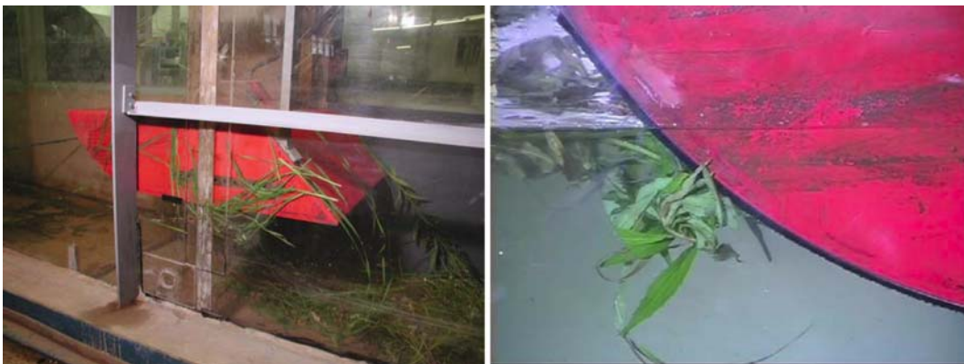
Abbildung 4.60: Gräser im Spalt (links), konstruktive Optimierung mittels Bürste (rechts).
