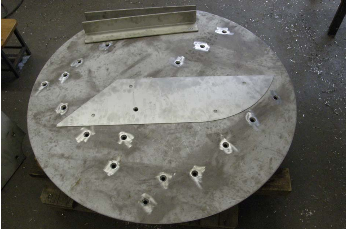
Abbildung A1-9: Fertigung und Montage des Schützes und der Schwingklappe in den Werkstätten des Tiefbauamtes Karlsruhe. Im Hintergrund ist das seitliche Führungsblech zu erkennen, darauf liegt eine fertig zugeschnittene Rippe der Schwingklappe (Stand 30.3.2009).
