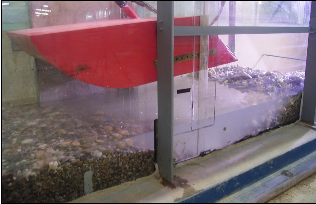
Abbildung 5.5: Ausgespülter Bereich unter der Schwingklappe
