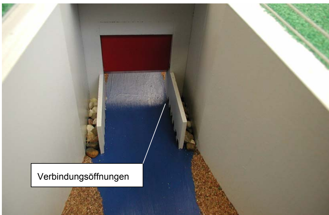
Abbildung 7.13: Blick von Unterstrom auf die seitliche Sohlstreifen
