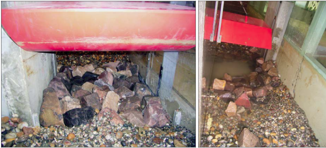
Abbildung 5.6: Befestigter Sohlbereich vor und nach dem Einstau
