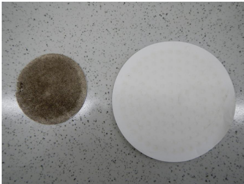
Abb. 32: Links ein Glasfaserfilter nach dem Ausklopfen der gefriergetrockneten oIF, rechts ein Polyethersulfonfilter nach dem Abspülen der gewonnenen Fraktion.
