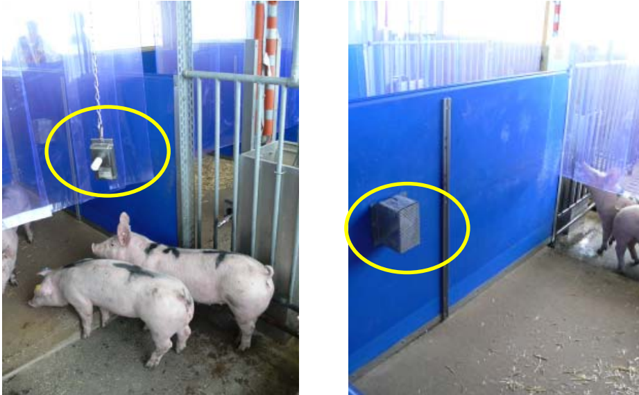
Abbildung 21/22: Kontrollmessungen mit Datenloggern im Aktivitäts- und Ruhebereich
