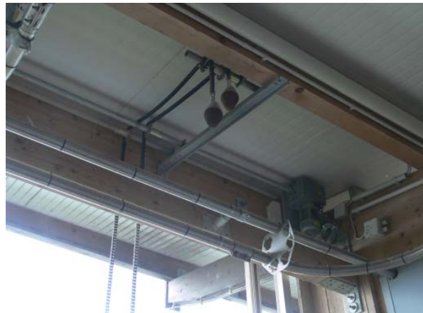
Abbildung 7/8: vertikales Bewegen von 3 Lichtstegplatten mit Kettenantrieb
