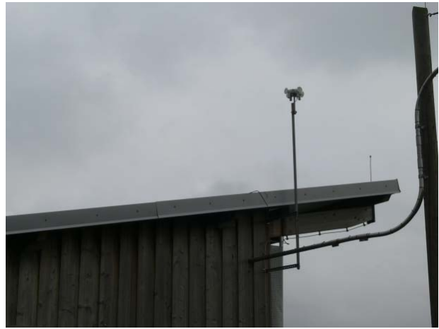
Abbildung 19/20: Zentrales Mastergerät, zentrale Messstelle auf dem Dach für Windgeschwindigkeit und Temperatur
