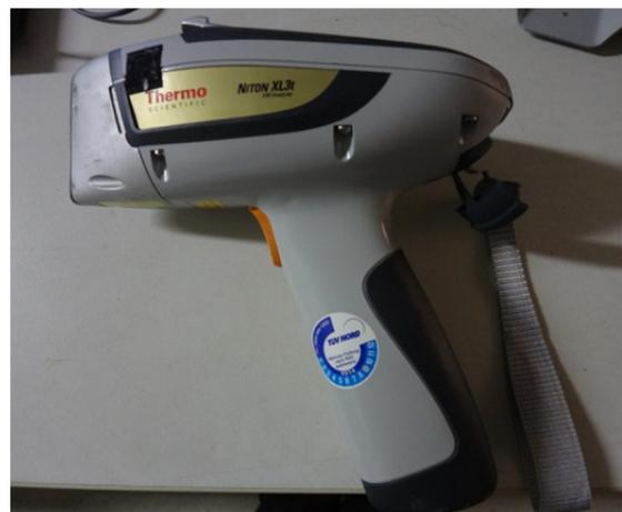
Abbildung 2-3 mobiles RF-Spektrometer NITON XL3t 900S [LUBW]
