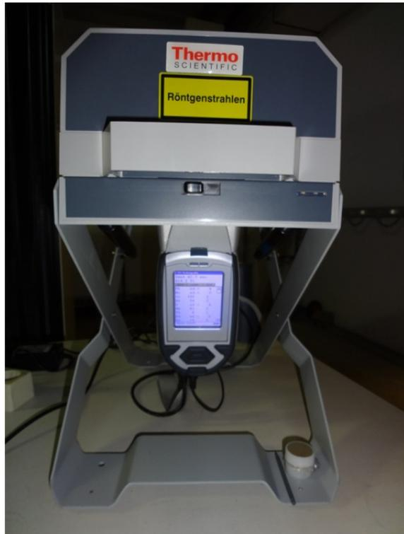
**Abbildung 2-4 Probenkammer (rechts mit eingehängtem Analysator während einer Messung [LUBW])**
