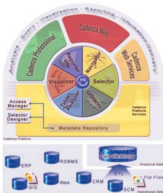
Abbildung 5.2: Aufbau der disy Cadenza Plattform mit Datenbankinfrastruktur [dis06a]
